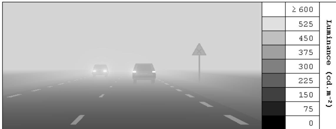
Figure 23 Visibilité dans le brouillard de jour (visibilité 100 m)
