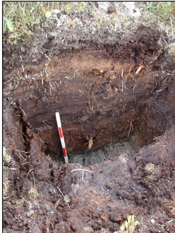
Photo 7 : Argile sous 1 m de tourbe dans un sondage du secteur 4, km 1 + 870, direction sud-ouest (154-00-0387-08-NUM1-48)
