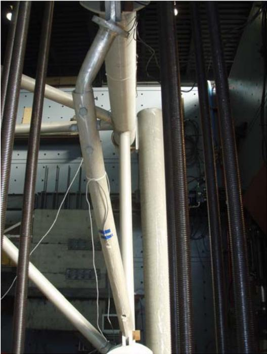
**Figure 22** Appui inférieur – Ovalisation du longeron et déformation de la semelle supérieure de la poutre d'appui
