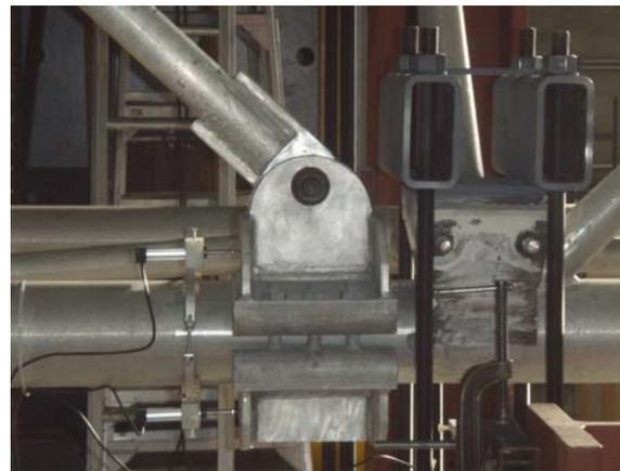
Bride assemblée sur le longeron inférieur près de l'assemblage longeron- barres Dywidag (côté Est).
