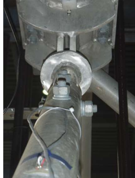
Assemblage par chevauchement et boulonnage – Instrumentation de la pièce RT1 de la diagonale de renfort télescopique.
