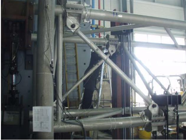
Vue d'ensemble du montage incluant les deux diagonales de renfort télescopique, les quatre brides et les deux groupes de barres Dywidag.
