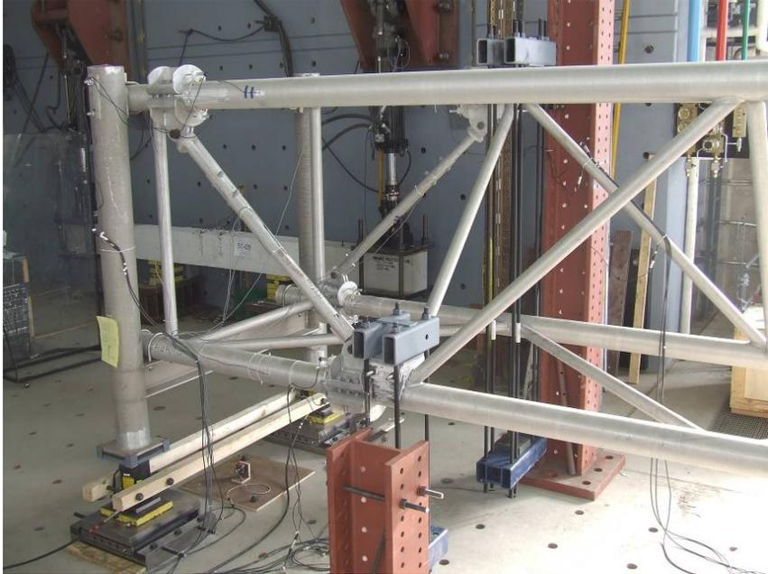
**Figure 15** Diagonales de renfort télescopiques et barres Dywidag
