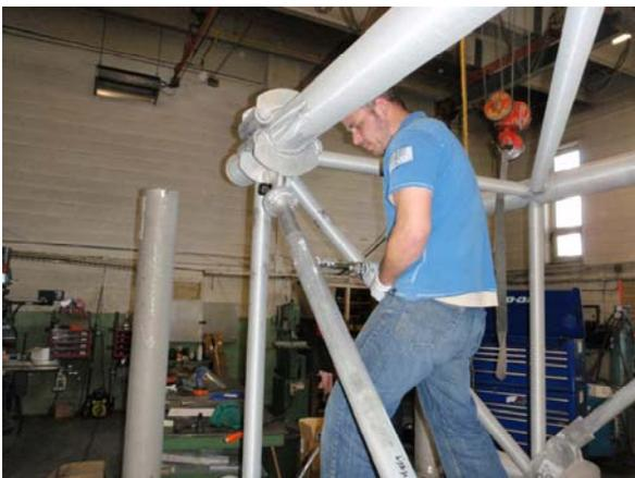
Étape finale – Les trous à l'extrémité de la pièce RT2 sont utilisés comme gabarit de percement de la pièce RT2.
