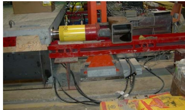
Figure 5 : Équipement de post-tension
