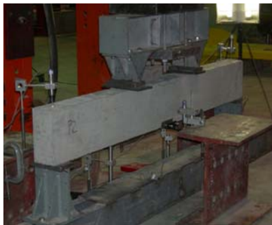
Figure 3 : Essais de validation en flexion non-armée
