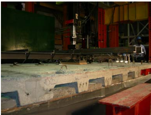
Figure 4 : Banc d'essais de dalles
