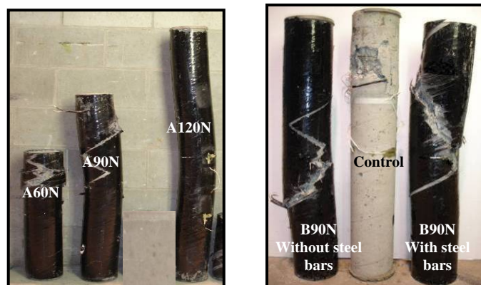
Figure 8 — Échantillons de colonnes après rupture
