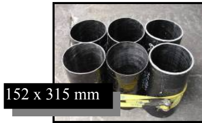
(a) Tube en PRFV avant le coulage du béton
