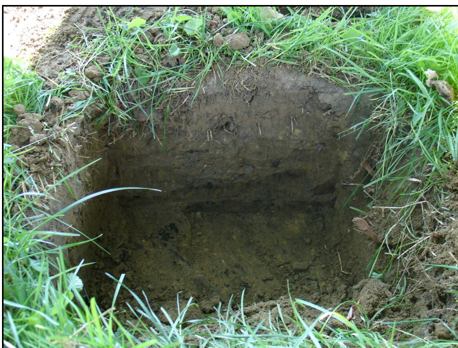
Photo 10 : projet 154-06-0953, municipalité de Champlain, route 138, stratigraphie, côté nord de la route, direction sud.
