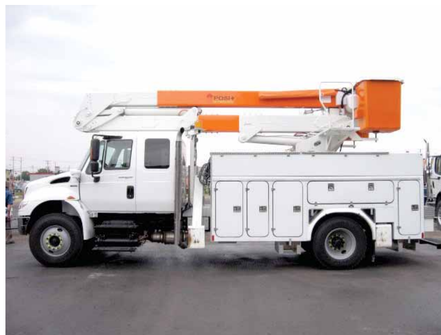
Camion muni d'un élévateur à nacelle hydraulique électrique mis au point par Posi-Plus.
