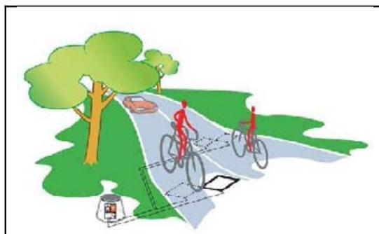
Figure 41. Illustration du système boucle magnétiques ZELT. (D'après Éco-compteur)
