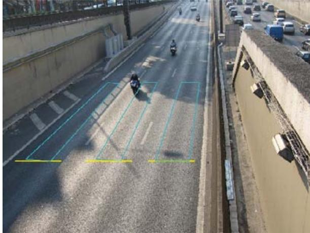
Figure 29. Illustration de la méthode de mesure tripline. Les vitesses des véhicules sont issues du rapport distance/vitesse à partir des zones encadrées, mais un calibrage est nécessaire. Les lignes jaunes indiquent la sortie de la zone considérée et permettent le comptage des véhicules.
