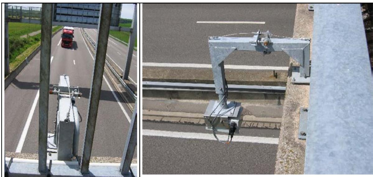
Figure 28. Détection par système infra rouge. Photographie d'un système infra rouge (ASIM TT 293). Le capteur est combiné avec un capteur à ultra sons et un radar.
