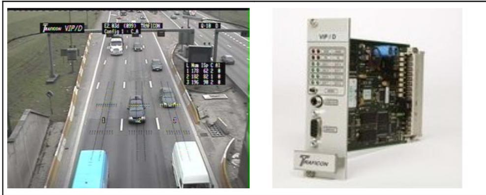
Figure 37. Illustration de la configuration du système VIP/D. (D'après <http://www.traficon.com/>)
