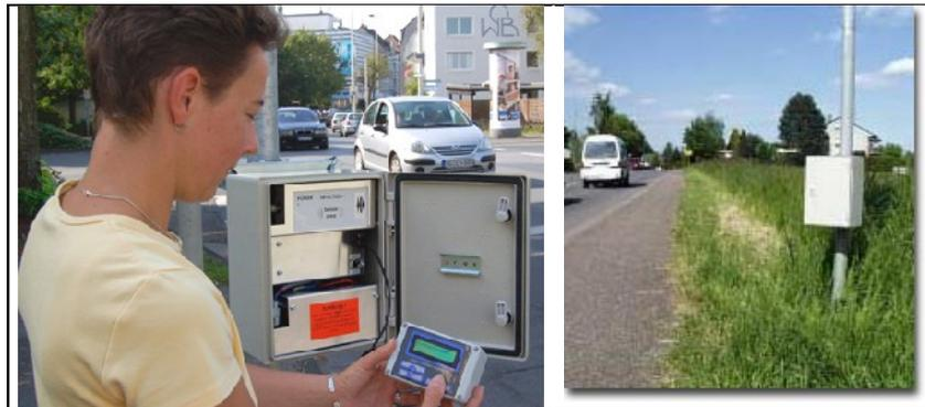
Figure 57. Illustration du système "wavetec traffic counter". (D'après la brochure Wavetec : <http://www.wavetec-online.com/fr/counter.htm>)
