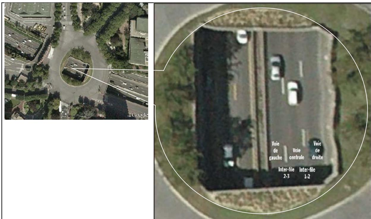
Figure 14. Photo de la configuration de la porte de la Plaine (à gauche) et schéma des positions possibles pour la section étudiée à 3 voies (à droite). Voie de gauche, inter-file 2-3, Voie centrale, inter-file 1-2 et voie de droite.
