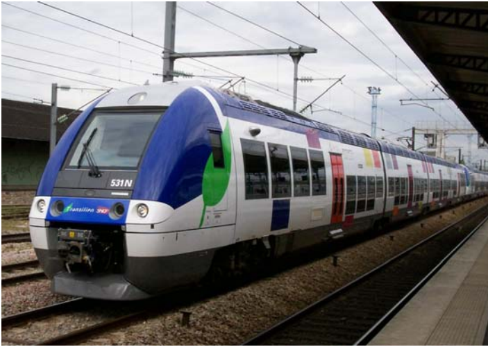
Figure 3-9 - Example of Single-Level Dual-Mode MU operated by Société Nationale des Chemins de fer Français (SNCF)
