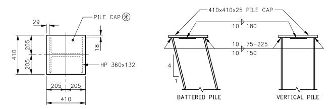
PILE CAP DETAILS FOR HP 360x132
