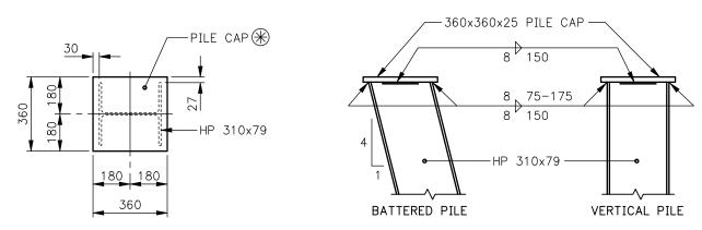
PILE CAP DETAILS FOR HP 310x79
