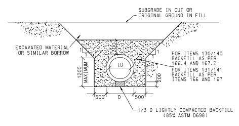
LIMITS OF BACKFILLING AROUND STRUCTURES
