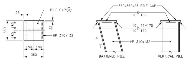
PILE CAP DETAILS FOR HP 310x132
