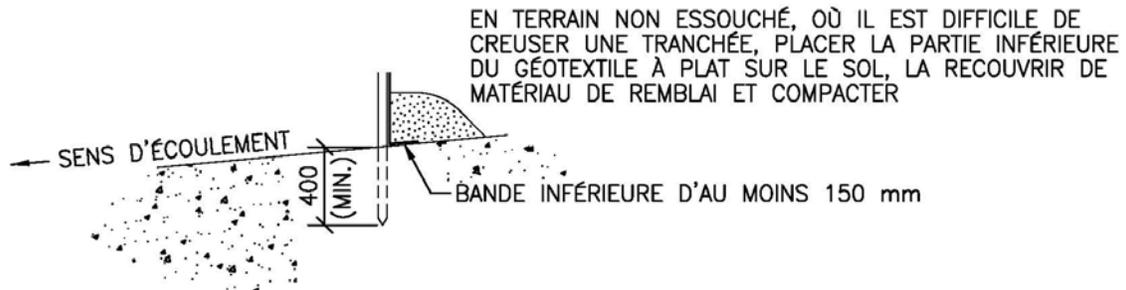
Installation d'une barrière de retenue des sédiments dans les zones non essouchées.
