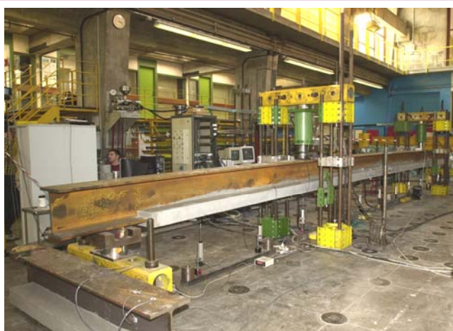
Essai d'une poutre préfléchie à talon BTHP au LCPC
