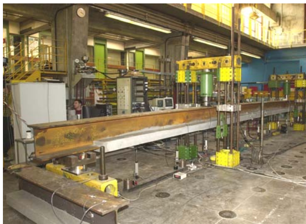
Réalisation d'une poutre préflechie à talon BTHP au LCPC
