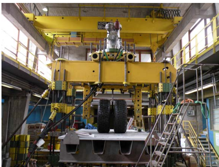
Essai d'une dalle orthotrope renforcée par une dalle en BFUP sur la plateforme d'essai des structures du LCPC (photo LCPC)
