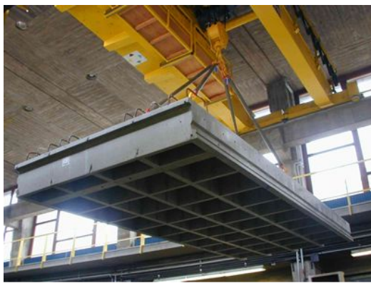
Prototype de dalle de pont en Béton Fibré à Ultra hautes Performances sur la plateforme d'essai des structures du LCPC
