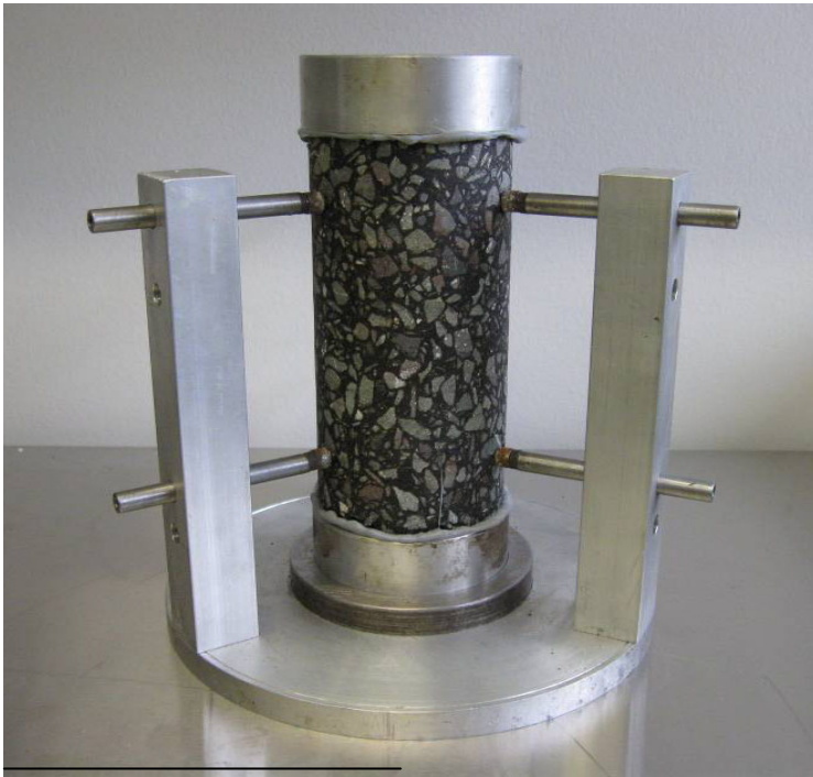
Figure 24 – Banc de collage pour les plots d'ancrage
