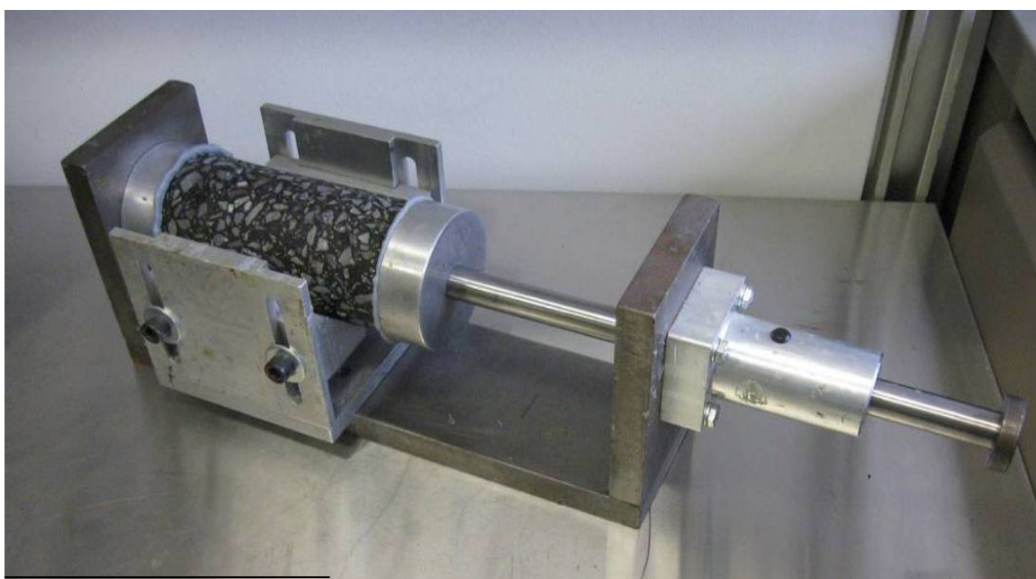
Figure 23 – Banc de collage pour les plateaux de chargement
