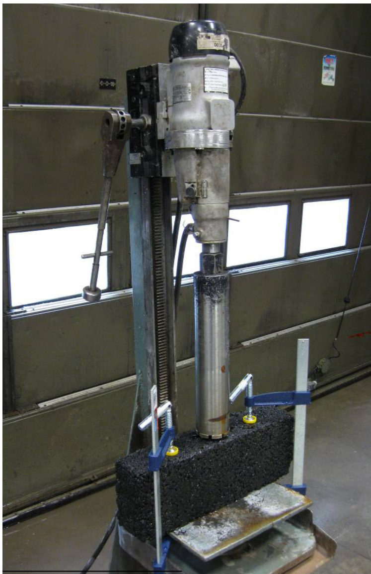
Figure 22 – Carotteuse pour le carottage des éprouvettes
