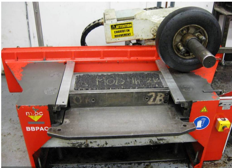
Figure 20 – Compacteur de plaque à pneu roulant du MTQ
