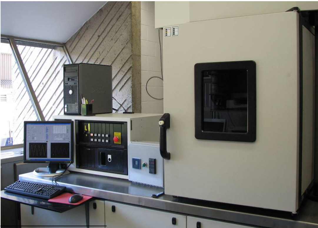
Figure 14 – Photo de la presse hydraulique asservie et de l'enceinte à température contrôlée
