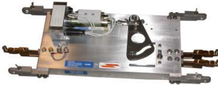
FIGURE 49: VUE DE HAUT D'UN AIGUILLAGE ÉLECTRIQUE À ÉLECTROAIMANT MONTRANT LE SYSTÈME D'ENTRAÎNEMENT
