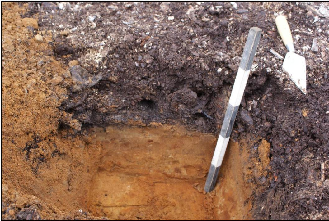
**Photo 25** Secteur 6, sondage, stratigraphie, couche de sciure de bois, chaînage 0+700, direction sud
