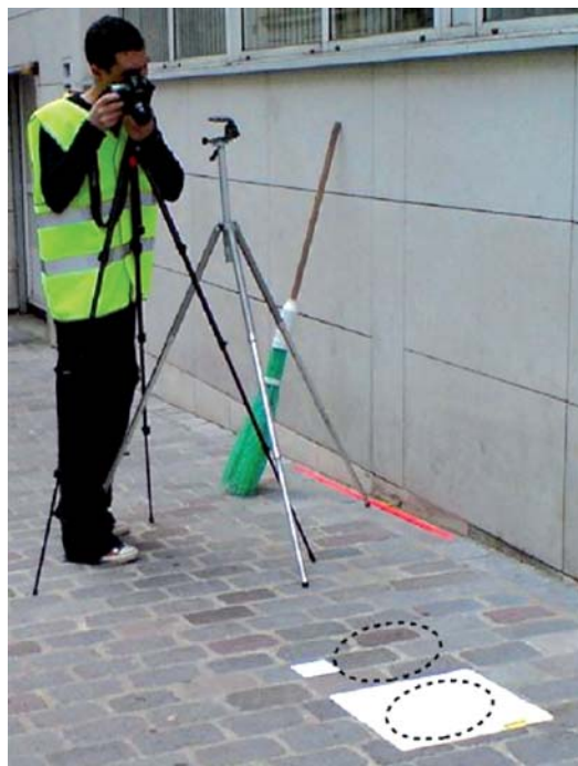
Protocole expérimental permettant d'évaluer le contraste des bandes d'éveil de vigilance avec leur environnement immédiat Source : Pierre Leroy et Cyril Chain
