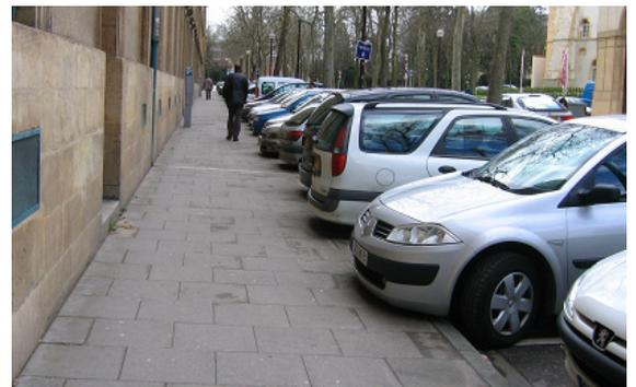
Stationnement en épi réduisant la largeur de cheminement en l'absence de butte-roues (Source : Cete de l'Est)
