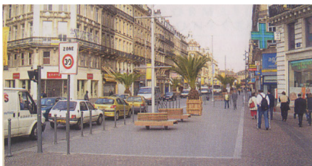
Mobilier regroupé sur une bande technique (Rue Faidherbe - Lille) Maîtrise d'œuvre : Pierre Gangnet (Source : Cete Méditerranée)
