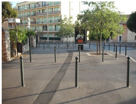
Multiplication des potelets anti-stationnement gênant les déplacements des PMR (Aix en Provence) (Source : Cete Méditerranée)
