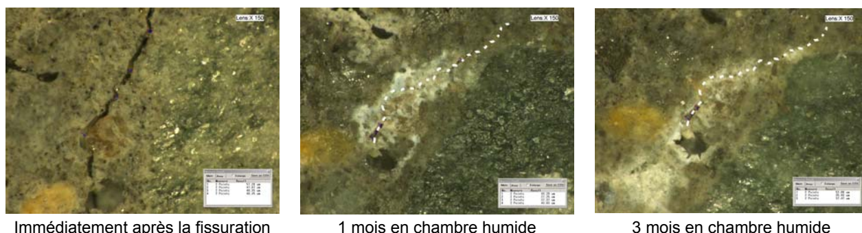
Figure 6. Aspect visuel d'une fissure de 64 \mu\text{m} immédiatement après la fissuration et après 1 et 3 mois de conservation en chambre humide ( E/C=0,35 )
