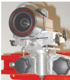
Figure 1(b) : cam era fix ee sur un support permettant de r egler son orientation en termes de piqu e, cap et horizontalit e
