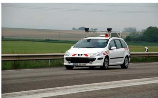
Figure 12 : véhicule expérimental d'acquisition en stéréovision de l'ERA 27
