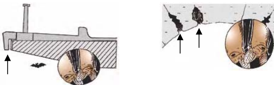
Figure 2 : exemples d'aménagements favorables à l'accueil des chauves-souris : espace libre entre la corniche et le tablier de l'ouvrage (à gauche), disjointement entre deux moellons (à droite) - Source : Sétra [30]
