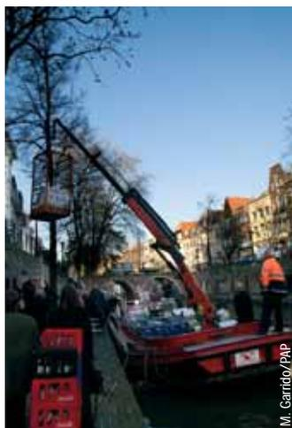
Le *bierboot* est équipé d'une grue dotée d'un bras de huit mètres prolongé d'une cage.
