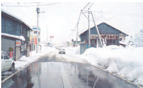
Figure 13 – Résultat de l'utilisation de gicleurs de fonte
