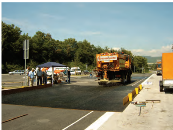
Zone d'essai sur la répartition de l'épandage
