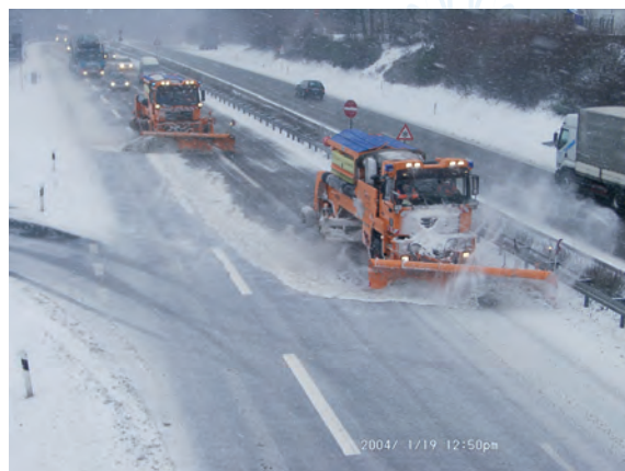
Déneigement en échelon à l'aide de véhicules d'entretien hivernal à hautes performances
