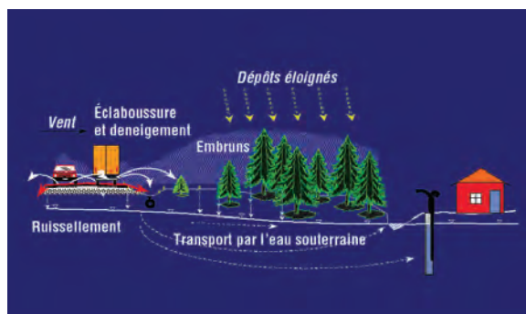
L'impact de l'exposition au sel de voirie apparaît d'abord sur la végétation et les eaux souterraines à proximité de la route.
