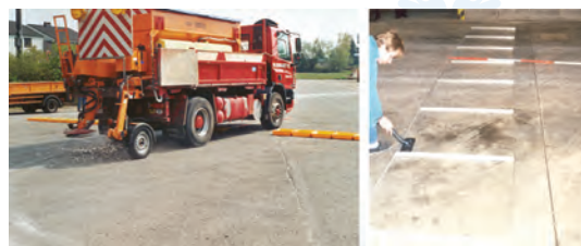
Aperçu du contrôle technique initial des épanduses pour l'épandage de sel humidifié (à gauche) et sec (à droite) – Région wallonne
