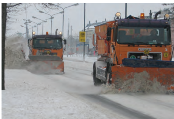
Figure 2 – Camions avec chasse-neige et équipement F30
