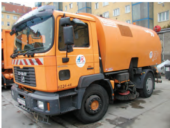
Figure 5 – Balai mécanique équipé pour l'épandage de saumure de chlorure de sodium
