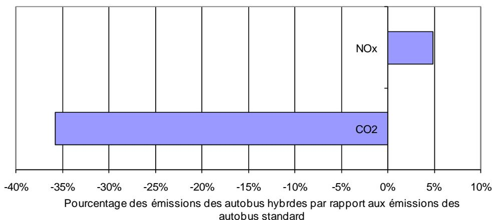
Les résultats des essais effectués au laboratoire d'Environnement Canada ont été obtenus en conditions idéales et contrôlées; ils ne sont pas directement comparables aux résultats obtenus en service clientèle. D'ailleurs, l'écart entre les résultats de consommation de carburant le démontre. (Voir Figures 3-1 et 3-4)
