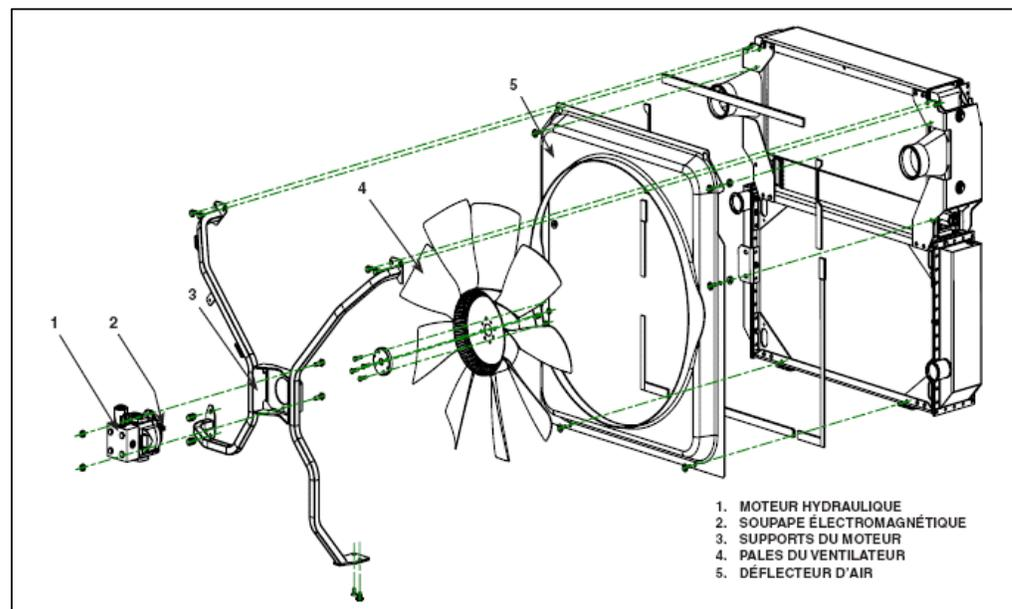
**Figure H-2 Les composantes hydrauliques avant la modification de la ventilation**
