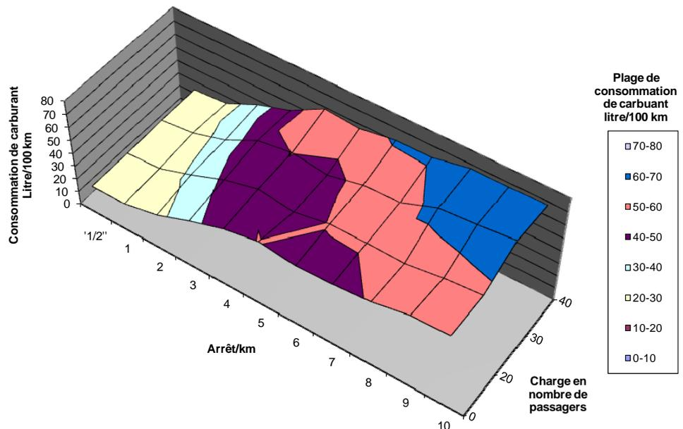
Ce graphique permet de constater que la consommation de carburant augmente graduellement en fonction du nombre d'arrêts par kilomètre et de la charge embarquée.
