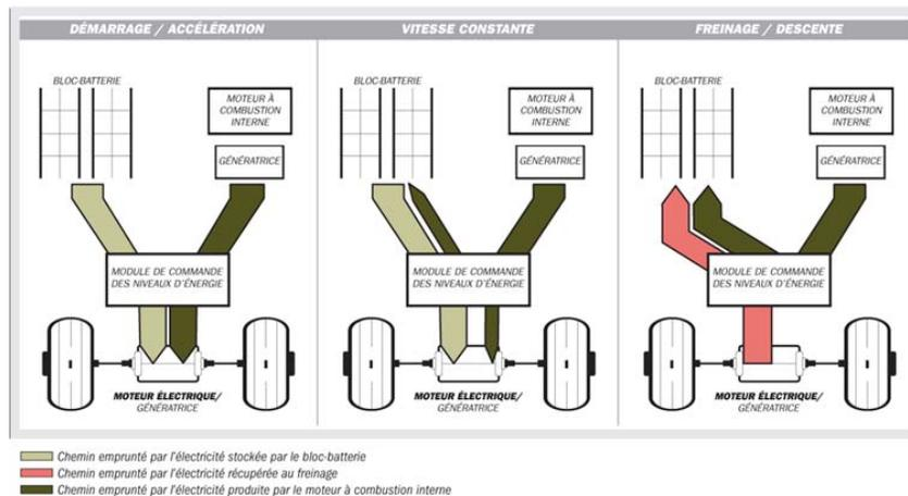
Les phases d'opération qui exigent le plus d'électricité sont la **mise en mouvement** et l'**accélération**. Au cours de ces phases, le moteur électrique est alimenté par l'électricité fournie par le boc-batterie et par l'électricité générée par le moteur à combustion interne<sup>2</sup>.
