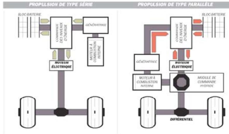
La figure A-1 présente les deux types de système de propulsion hybrides, mais comment fonctionnent-ils? Prenons le système de type **Série**, illustré à la figure A-2, pour expliquer leur fonctionnement, puisqu'il est conceptuellement plus simple que le système de type **Parallèle**, ce dernier n'étant qu'une variante du premier.
