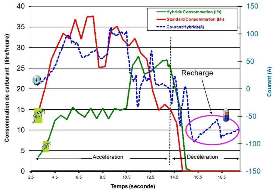
On peut observer que l'énergie de remplacement pour le véhicule hybride lors de cette accélération provient de la batterie. Lors de la décélération, l'ampérage au niveau de la batterie est de signe inverse, cela indique qu'elle est en phase de régénération. Les deux moteurs électriques dans la transmission deviennent une génératrice, tout en ralentissant le véhicule.
