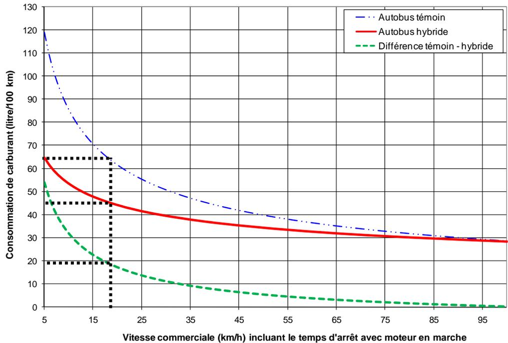
**Note :** Moyenne des résultats récoltés sur une année, avec une vitesse moyenne d'environ 18 km/h, une température minimale de -28,5 °C, une température maximale de 33,4 °C et une température moyenne de 6,6 °C ainsi que 34 % de temps pendant lequel le moteur a tourné au ralenti. Cette courbe s'applique pour des autobus sans air climatisé et avec transmission ZF sur les témoins.
