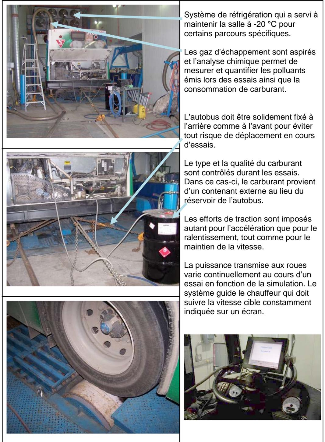
En tout, dix essais ont été réalisés. Dans le but de mesurer l'impact des températures estivales et hivernales sur les performances des autobus hybrides et réguliers, des tests à +20 °C et à -20 °C ont été réalisés. Enfin, puisque les autobus de la STO sont équipés d'un système de climatisation réfrigérante, des essais où la climatisation était éteinte et où elle
