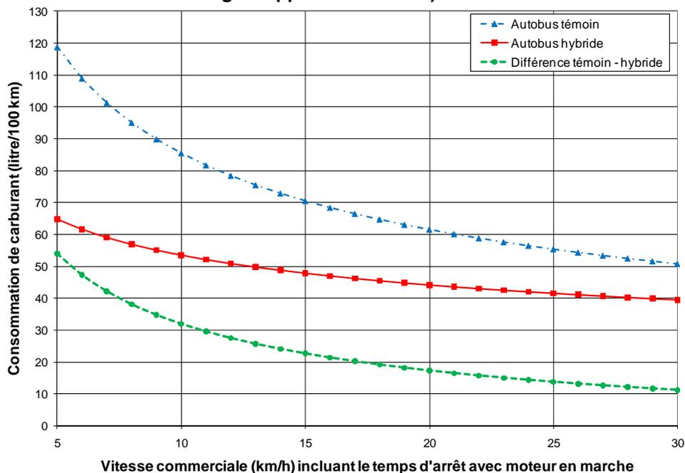
**Note :** Moyenne des résultats récoltés sur une année, avec une vitesse moyenne d'environ 18 km/h, une température minimale de -28,5 °C, une température maximale de 33,4 °C et une température moyenne de 6,6 °C ainsi que 34 % de temps de fonctionnement au ralenti. Cette courbe s'applique pour des autobus sans air climatisé et avec transmission ZF sur les témoins et Allison Electric Drive EP-40 sur les hybrides.
