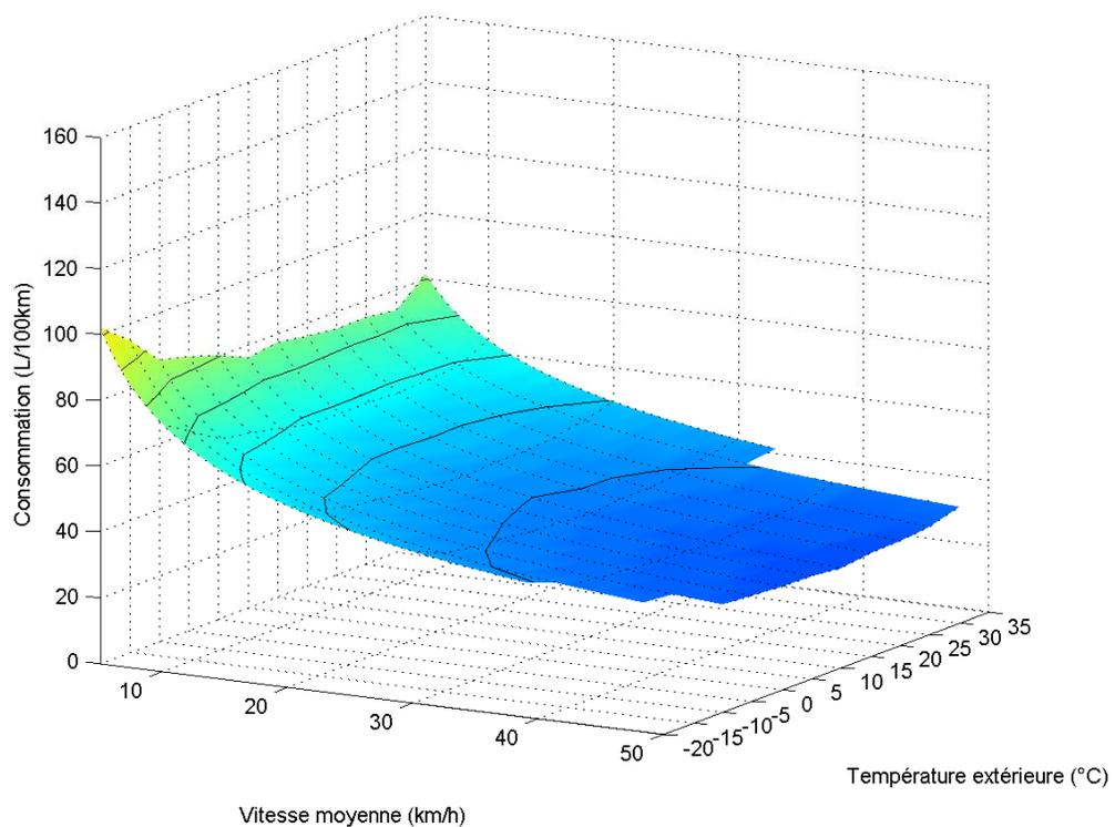
**Figure D-13** Consommation de carburant en fonction de la vitesse moyenne et de la température extérieure - Différence entre les autobus 2008 témoins et hybrides
