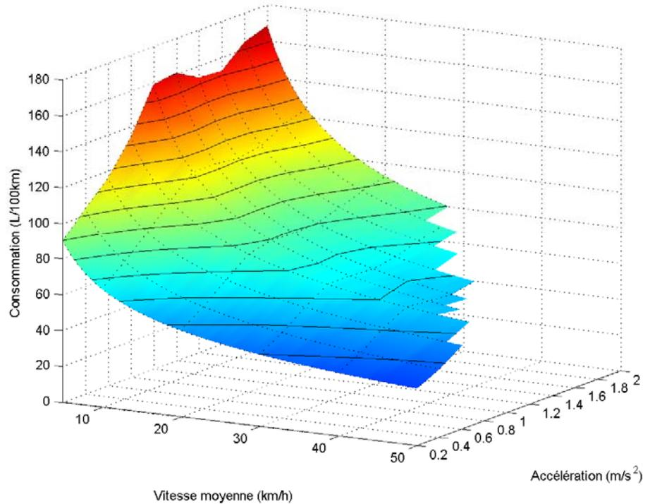
**Figure D-7** Consommation de carburant en fonction de la vitesse moyenne et du taux moyen d'accélération- Autobus hybride 2008
