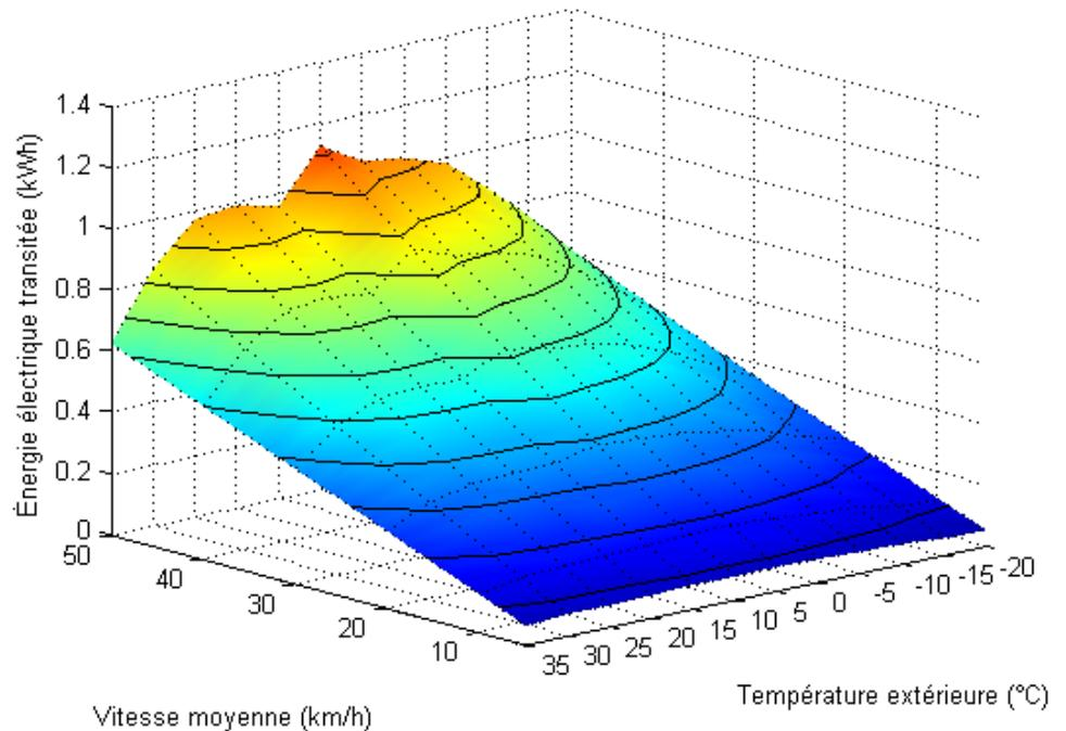
**Figure D-11** Consommation de carburant en fonction de la vitesse moyenne et de la température extérieure - Autobus témoin 2008
