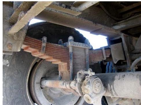
Figure 5 : ressort à lames - Photo M. Bereni
