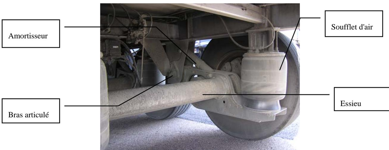
Figure 10 : exemple de suspension pneumatique - Crédits Sétra
