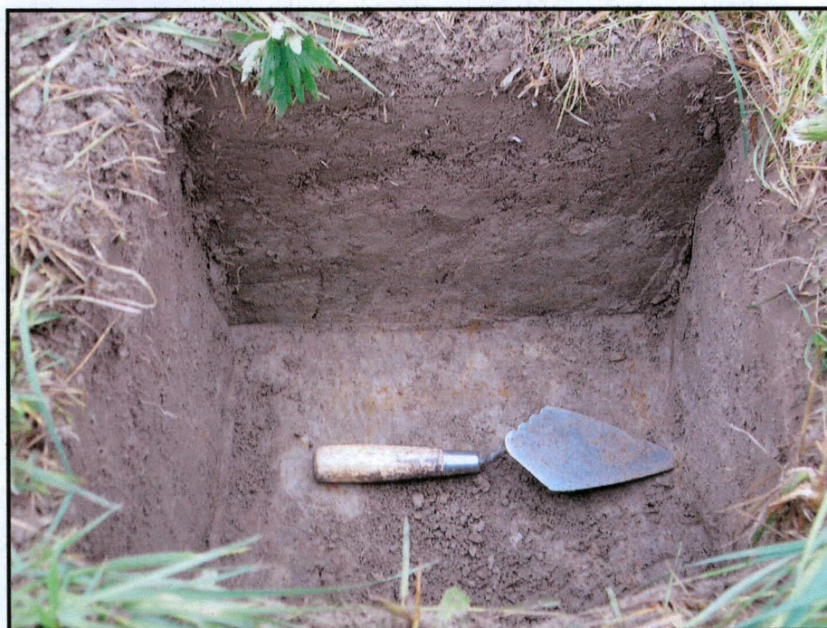
Photo 32 Projet n°154-99-1227 (20-5575-9911), route 309, municipalité de Saint-Aimé-du-Lac-des-îles, stratigraphie observée dans la paroi ouest d'un sondage et correspondant à un sol argileux, vers l'ouest.
