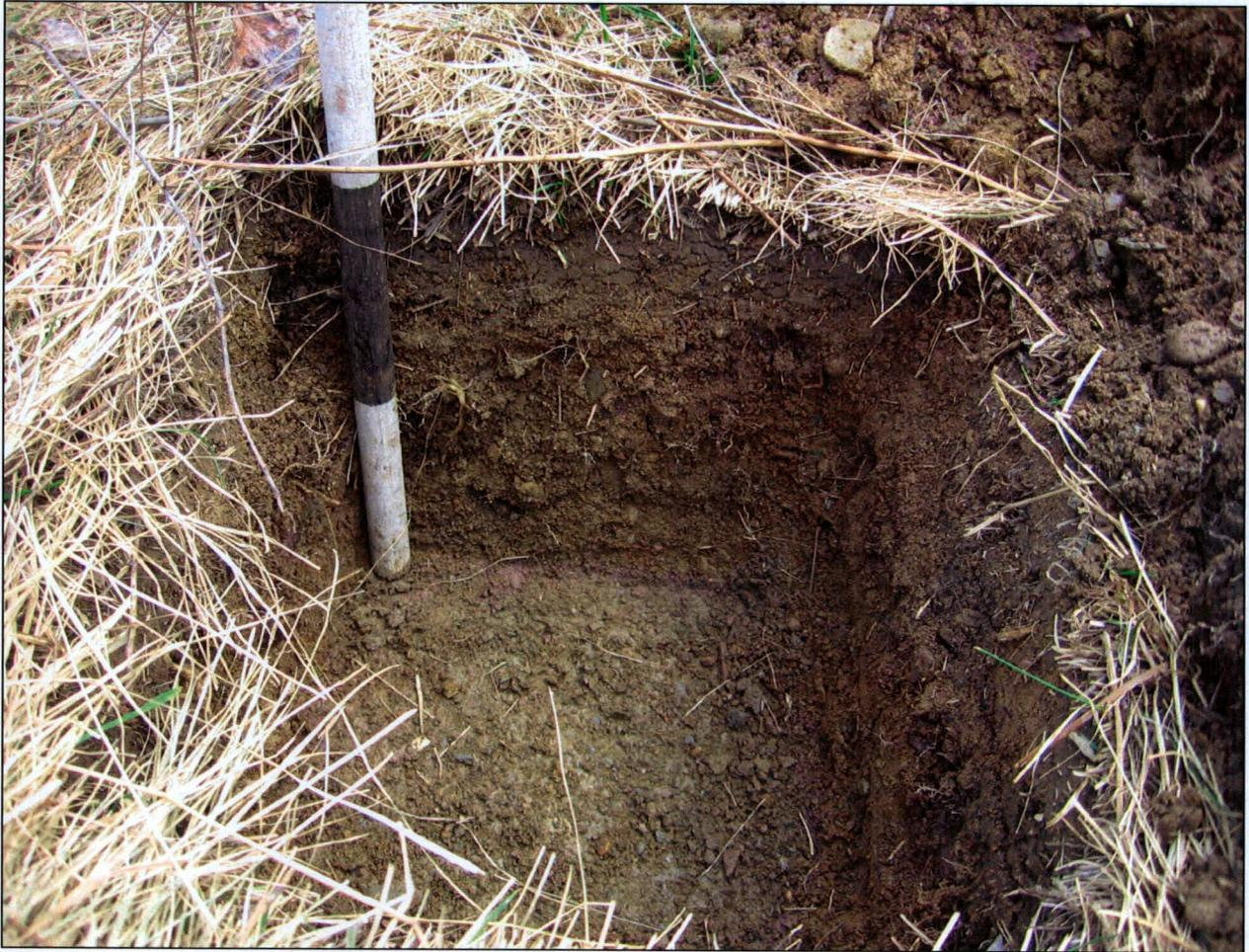
Photo 11 : Paroi nord d'un sondage réalisé du côté nord de la route 132, vis-à-vis du km 3+730, remblai de 0,20 m d'épaisseur superposé à un niveau de gravier très dense, ville de Chandler, direction nord (20-3172-7802-C-07-NUM1-16)
