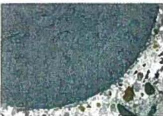
◀ Après une durée de vie similaire, la corrosion de la barre d'acier oxydée a dégradé le béton qui l'entoure alors que la barre V•ROD est intacte dans un béton sain.
