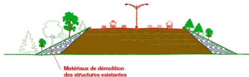
Phase 4 Aménagement et remblai (2 e phase)
