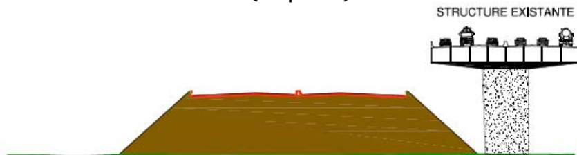
Phase 1 et 2 Construction du remblai (1 re phase)
