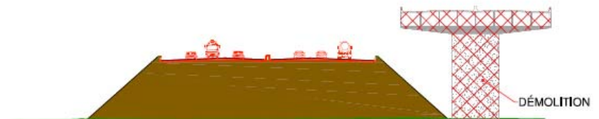
Phase 3 Mise en service des nouvelles voies et démolition de la structure existante
