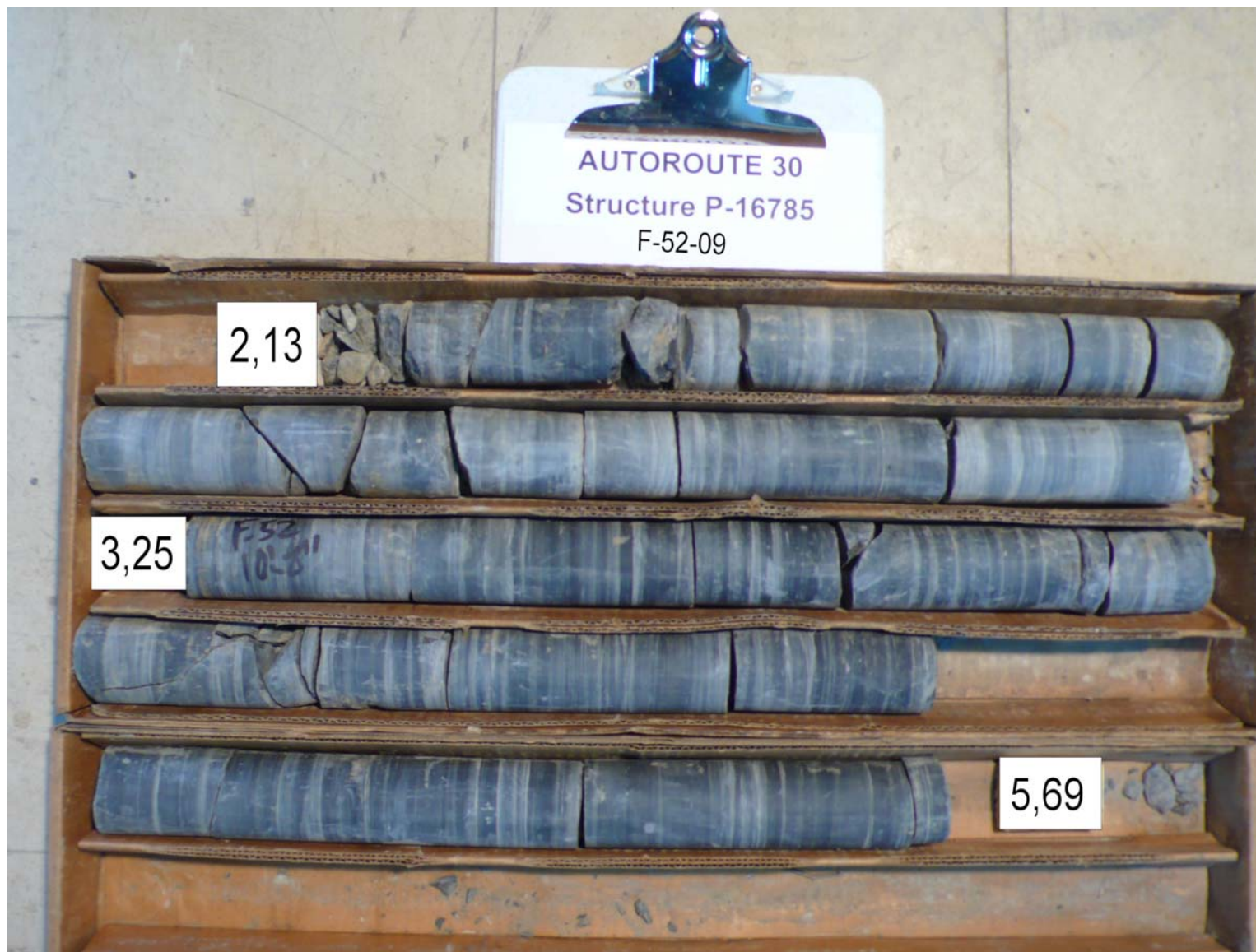
Photo 2 Carottes de rocher récupérées dans le forage F-52-09
