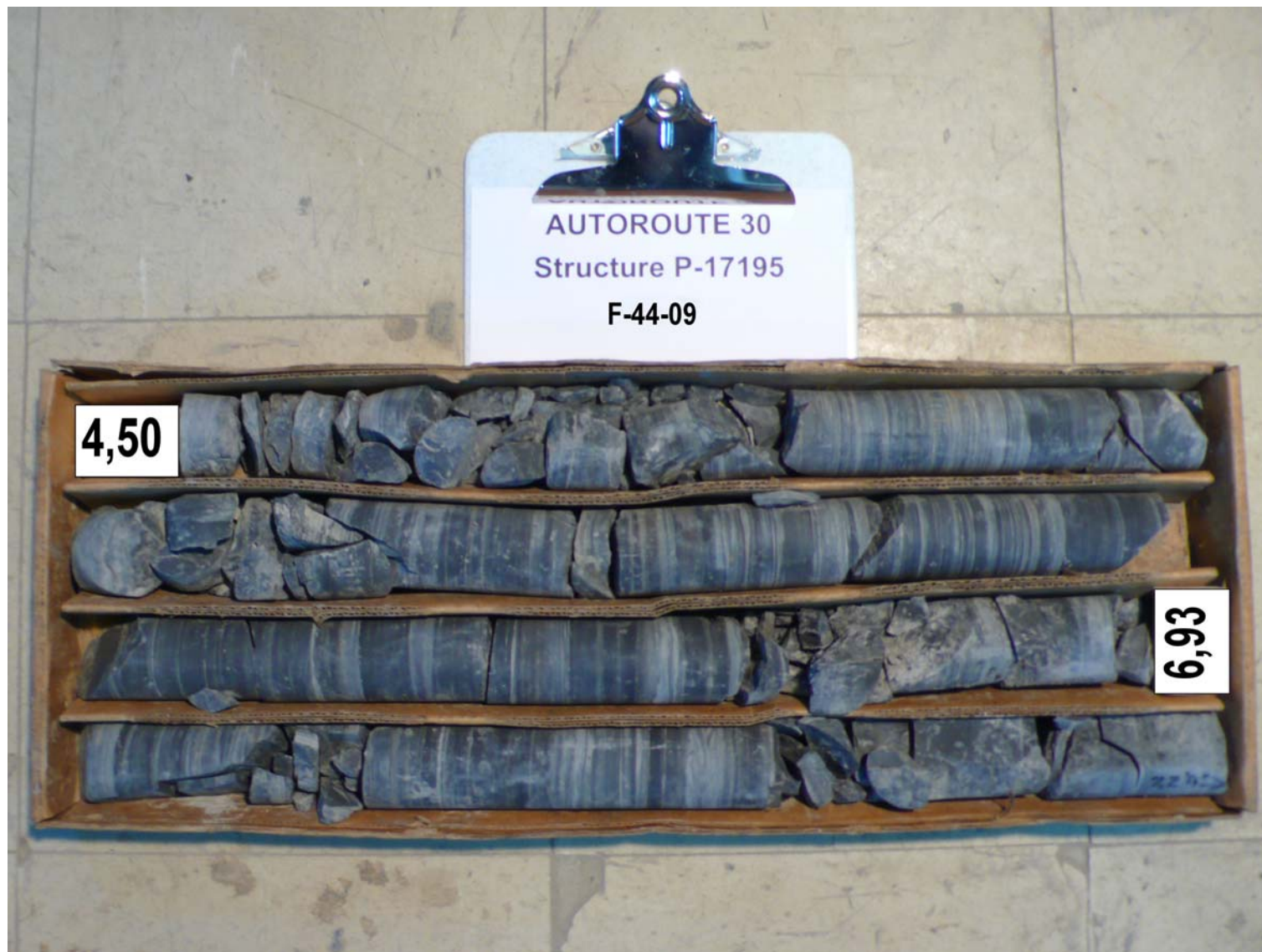
Photo 4 Carottes de rocher récupérées dans le forage F-44-09
