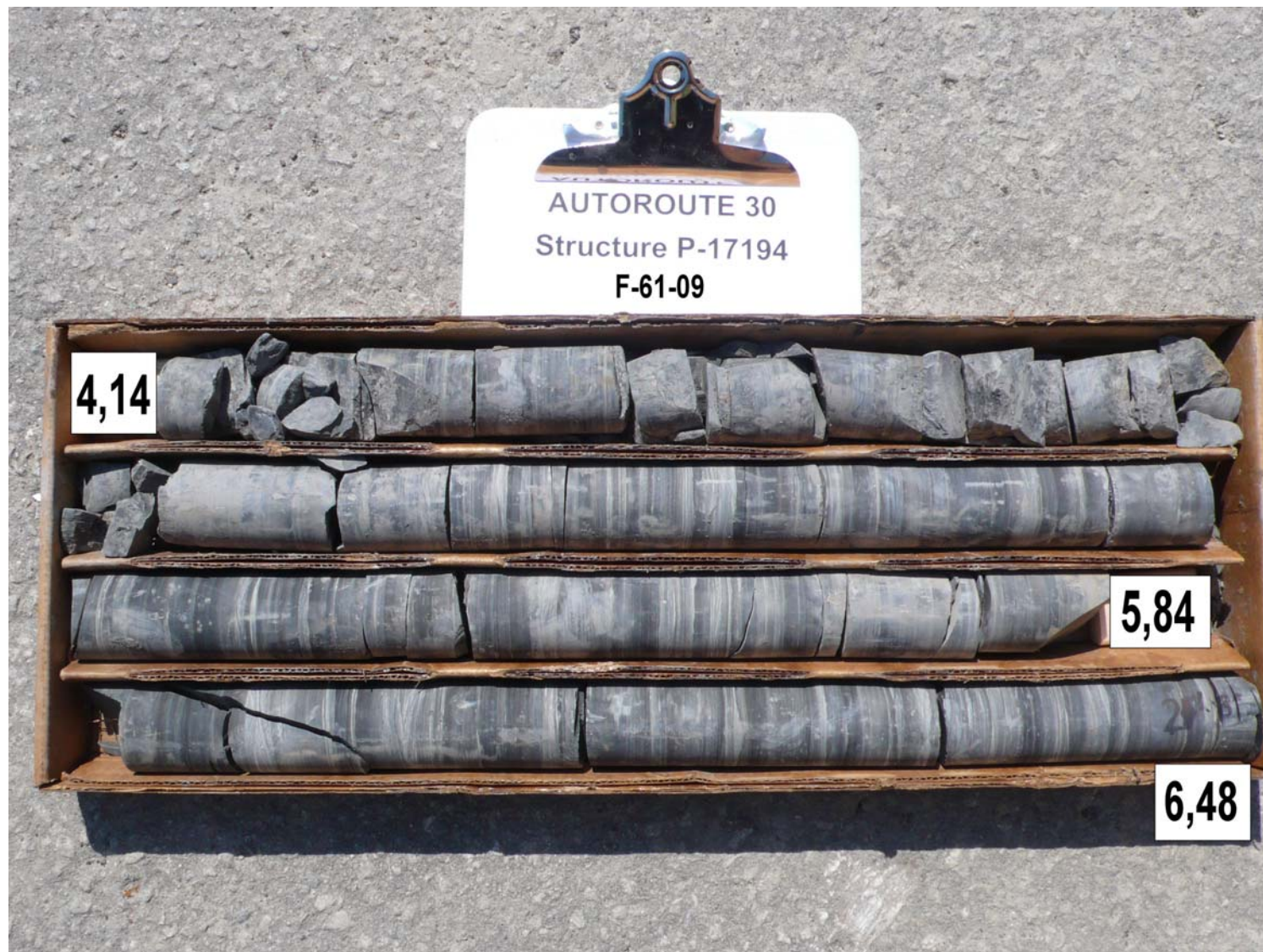
Photo 5 Carottes de rocher récupérées dans le forage F-61-09
