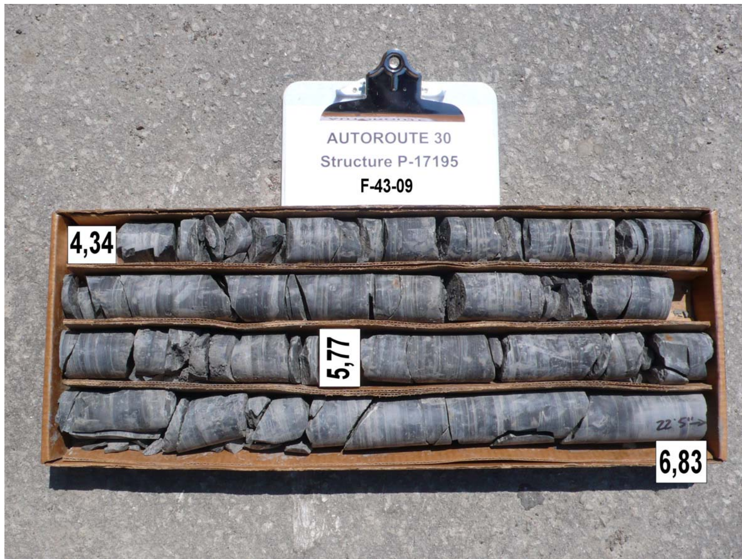
Photo 3 Carottes de rocher récupérées dans le forage F-43-09
