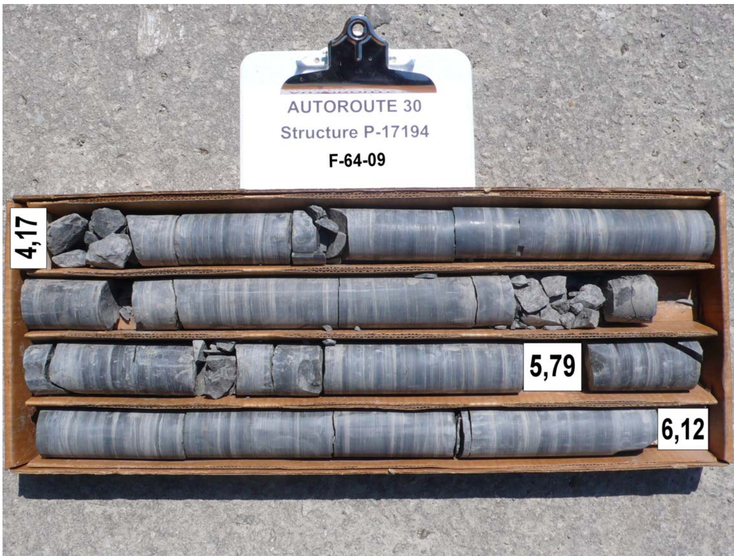
Photo 8 Carottes de rocher récupérées dans le forage F-64-09
