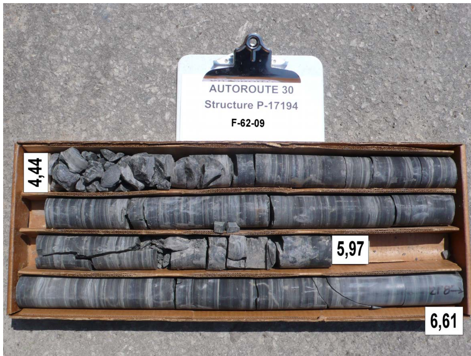
Photo 6 Carottes de rocher récupérées dans le forage F-62-09
