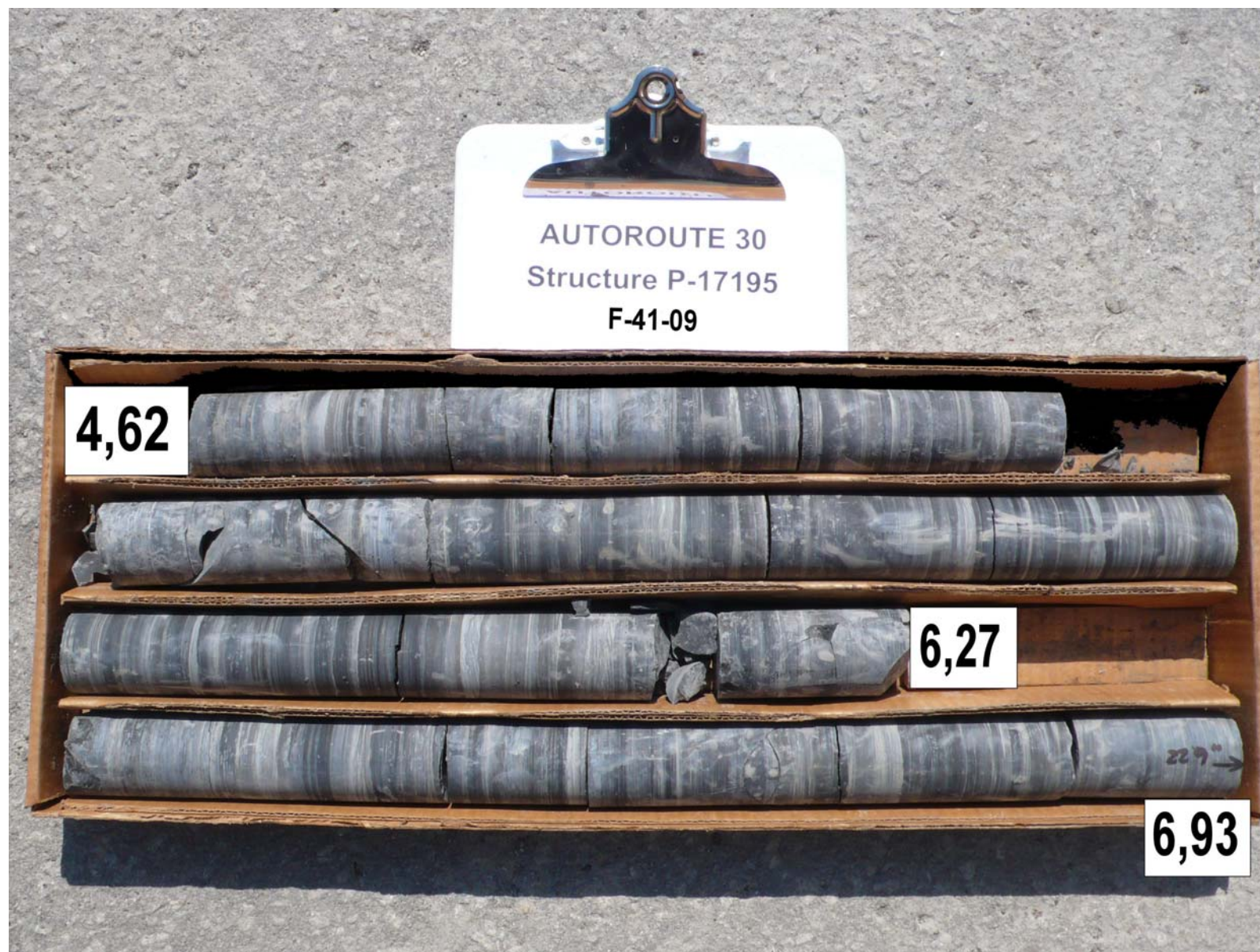
Photo 1 Carottes de rocher récupérées dans le forage F-41-09
