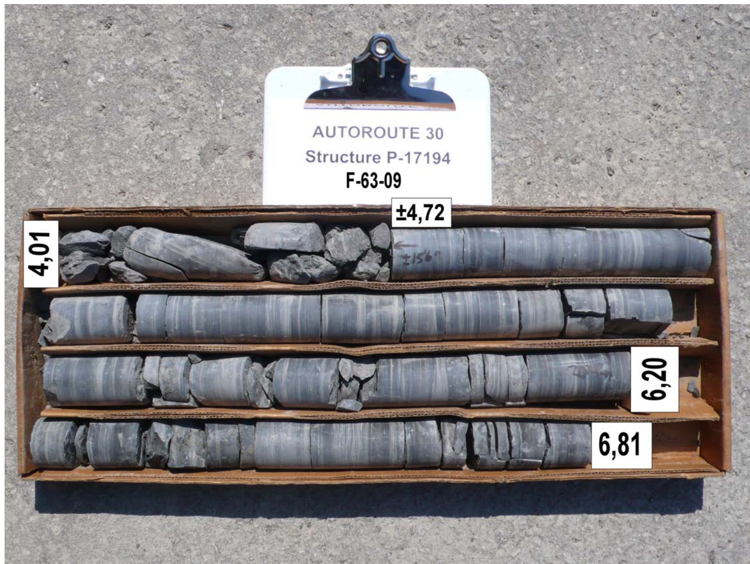
Photo 7 Carottes de rocher récupérées dans le forage F-63-09
