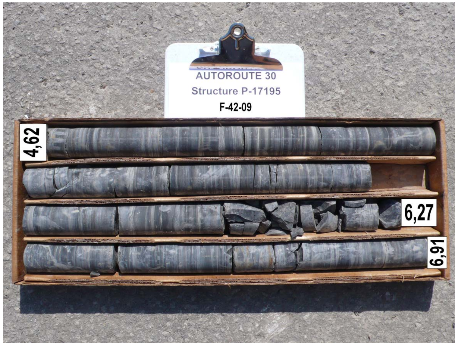
Photo 2 Carottes de rocher récupérées dans le forage F-42-09
