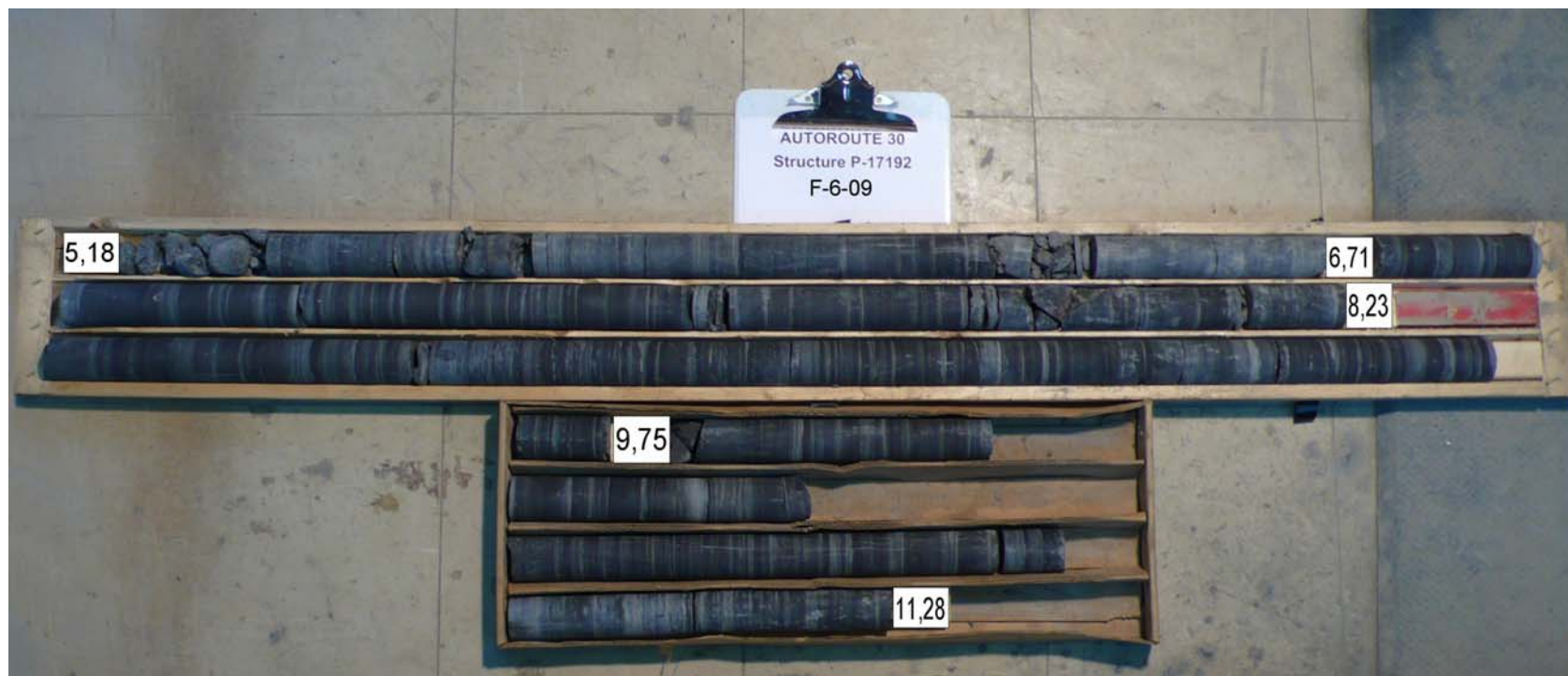
Photo 6 Carottes de rocher récupérées dans le forage F-6-09
