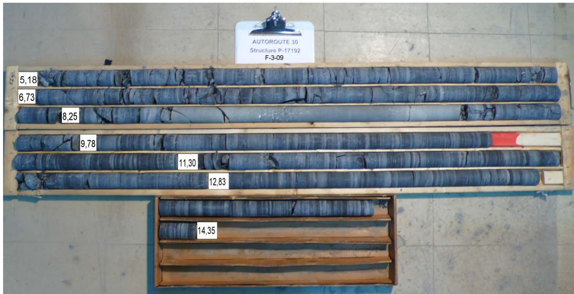
Photo 3 Carottes de rocher récupérées dans le forage F-3-09
