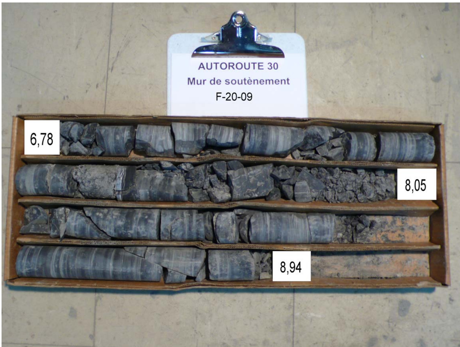
Photo 20 Carottes de rocher récupérées dans le forage F-20-09
