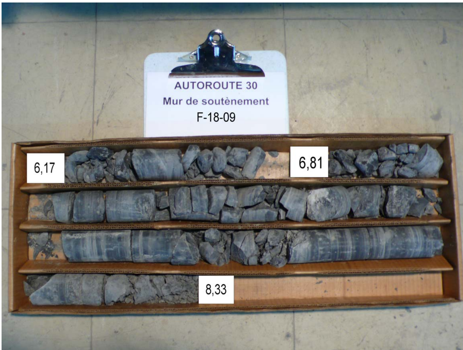
Photo 18 Carottes de rocher récupérées dans le forage F-18-09
