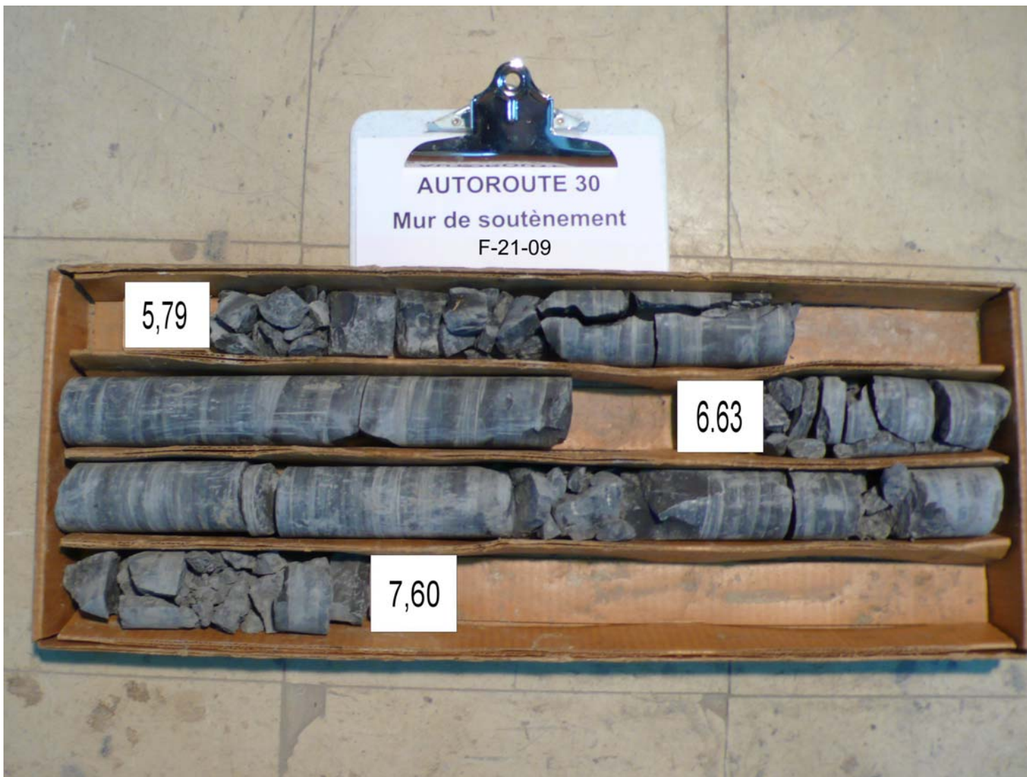
Photo 21 Carottes de rocher récupérées dans le forage F-21-09
