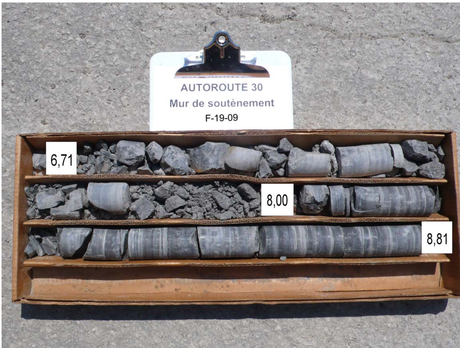
Photo 19 Carottes de rocher récupérées dans le forage F-19-09
