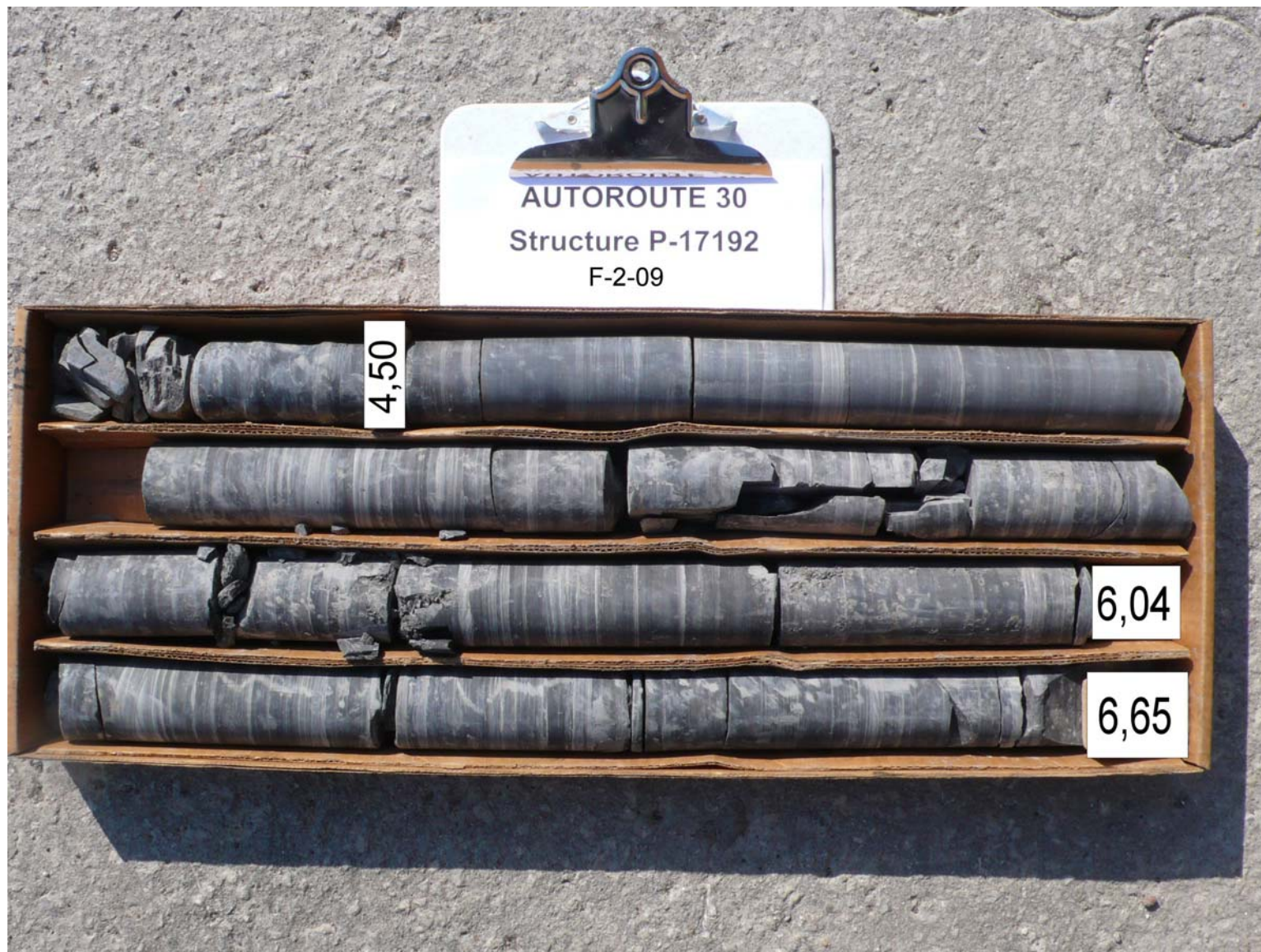
Photo 2 Carottes de rocher récupérées dans le forage F-2-09
