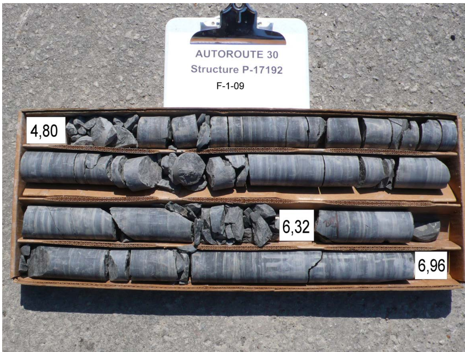
Photo 1 Carottes de rocher récupérées dans le forage F-1-09
