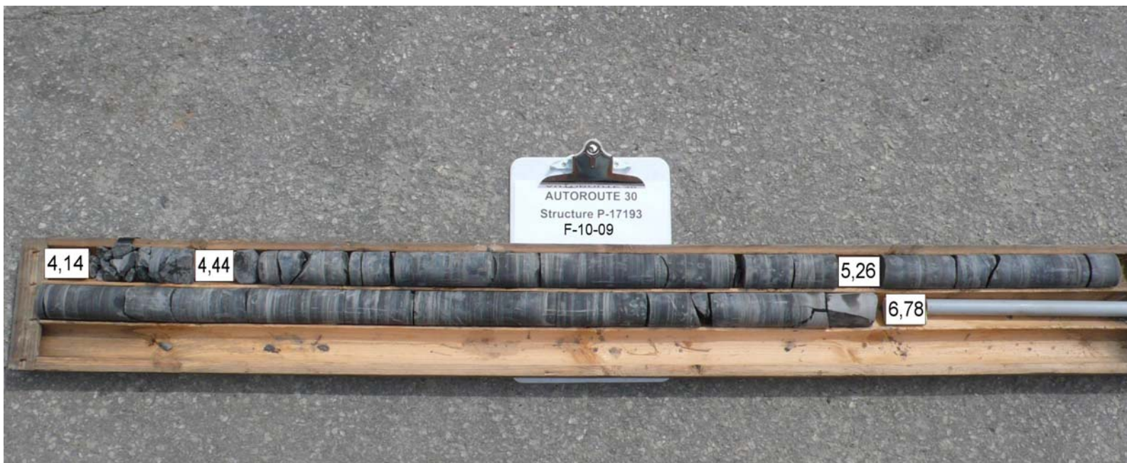
Photo 10 Carottes de rocher récupérées dans le forage F-10-09
