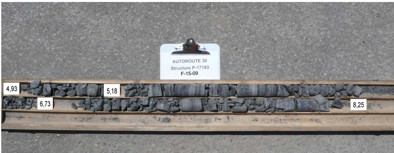
Photo 15 Carottes de rocher récupérées dans le forage F-15-09
