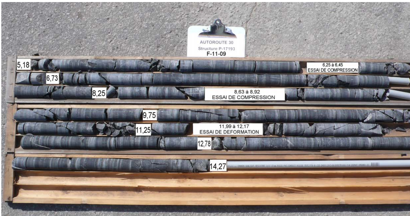
Photo 11 Carottes de rocher récupérées dans le forage F-11-09
