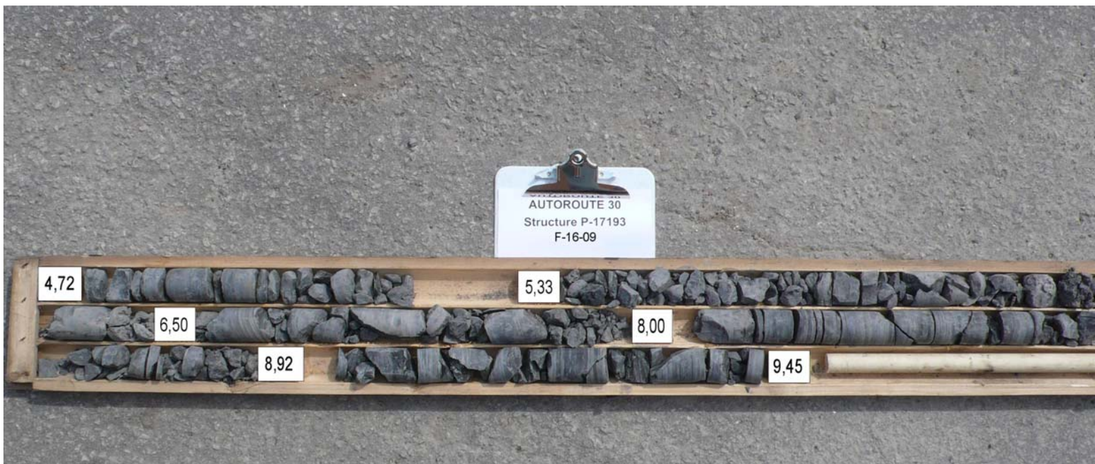
Photo 16 Carottes de rocher récupérées dans le forage F-16-09
