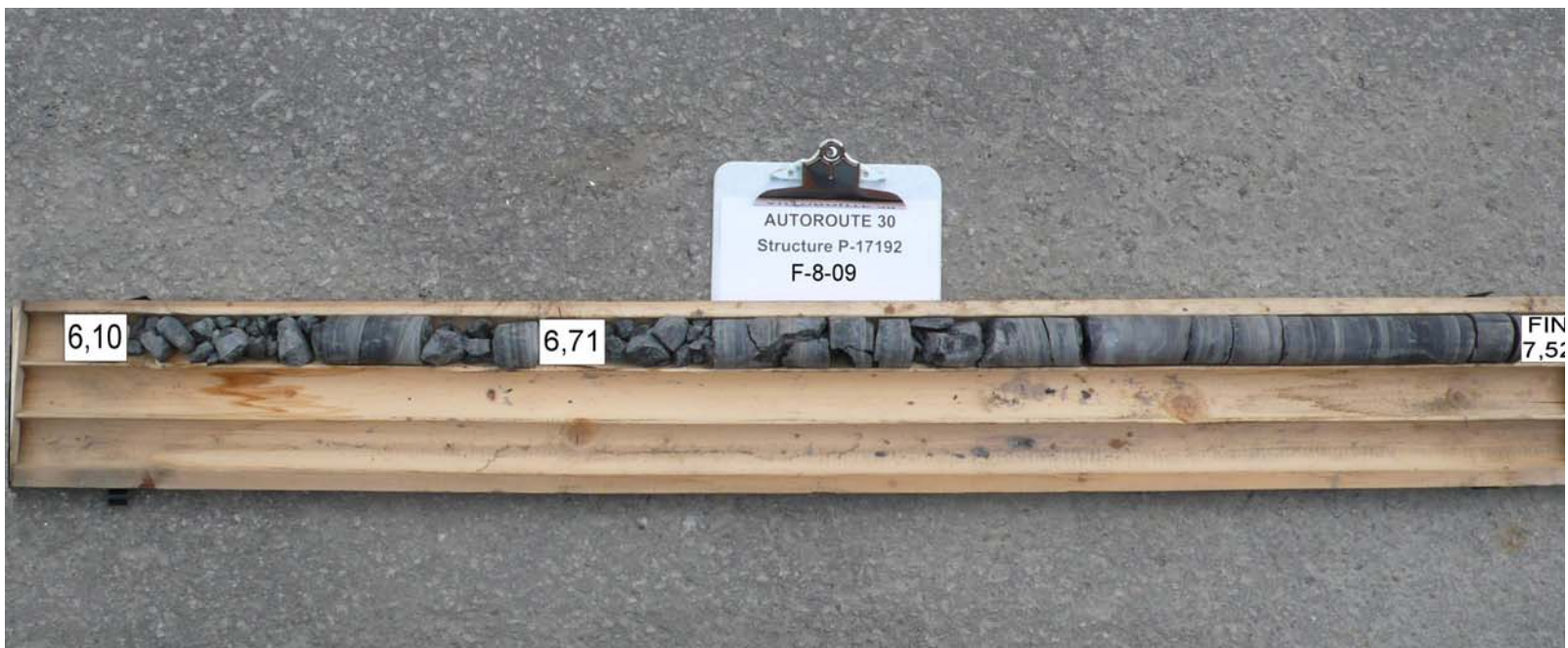
Photo 8 Carottes de rocher récupérées dans le forage F-8-09
