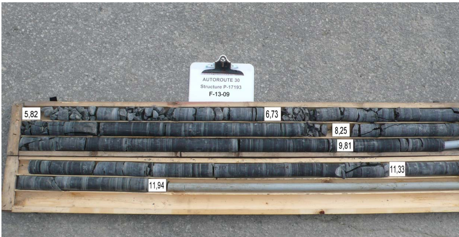
Photo 13 Carottes de rocher récupérées dans le forage F-13-09
