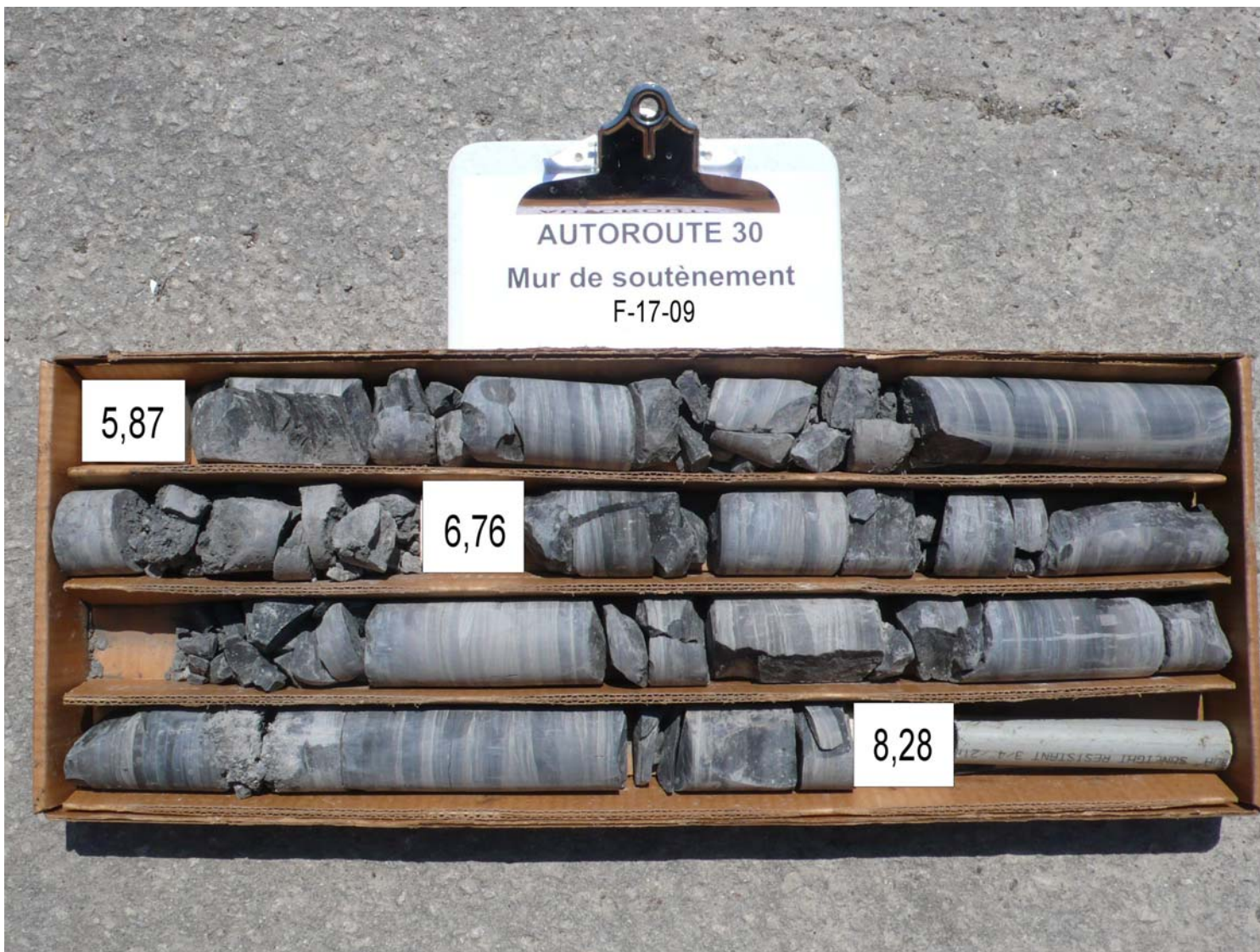
Photo 17 Carottes de rocher récupérées dans le forage F-17-09
