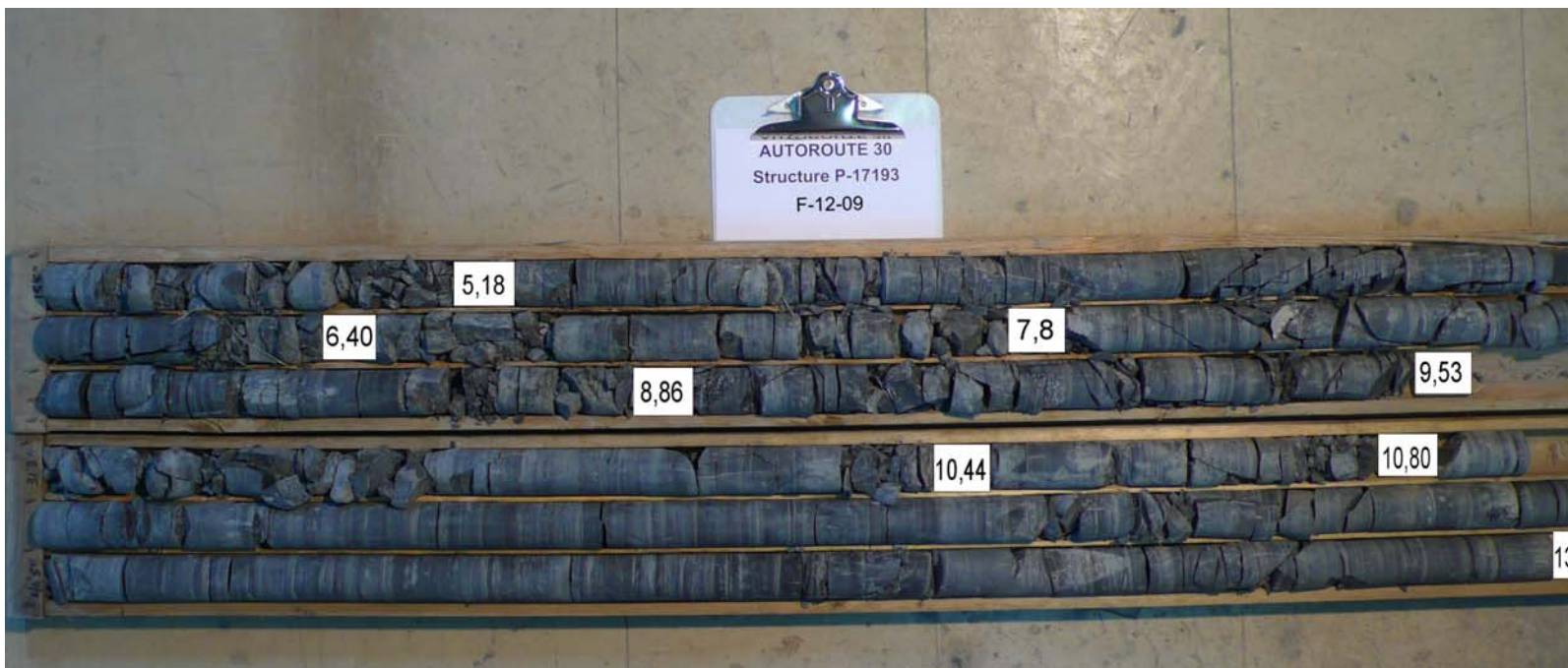
Photo 12 Carottes de rocher récupérées dans le forage F-12-09
