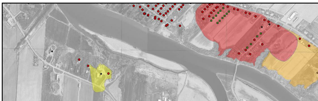
Figure 4 : Exemple de carte de risque pour le danger de coulée argileuse
