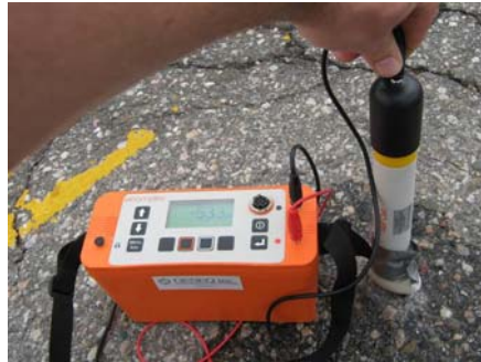
Fig. 3 : Mesure de potentiel de corrosion
