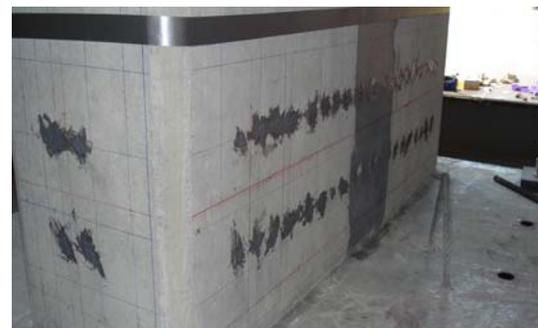
**Figure 18** – Photo de S4 avant l'installation du gainage en matériaux composite
