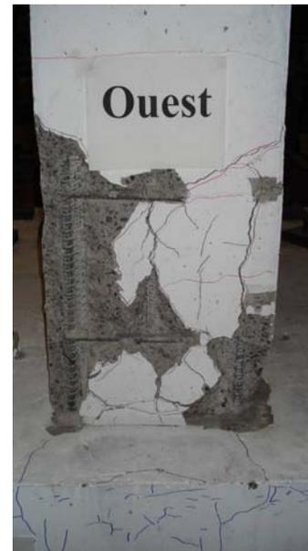
Figure 9 – État de la face ouest à la fin de l'essai
