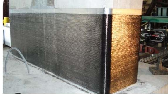
**Figure 6** – Pilier renforcé à l'aide de matériaux composites
