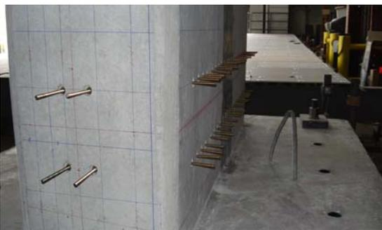
**Figure 17** – Photo de S4 une fois les ancrages installés
