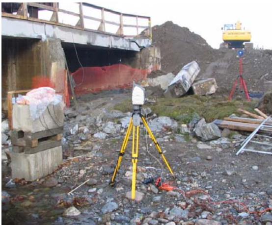
Figure 10 – Système d'arpentage de haute précision à balayage infrarouge
