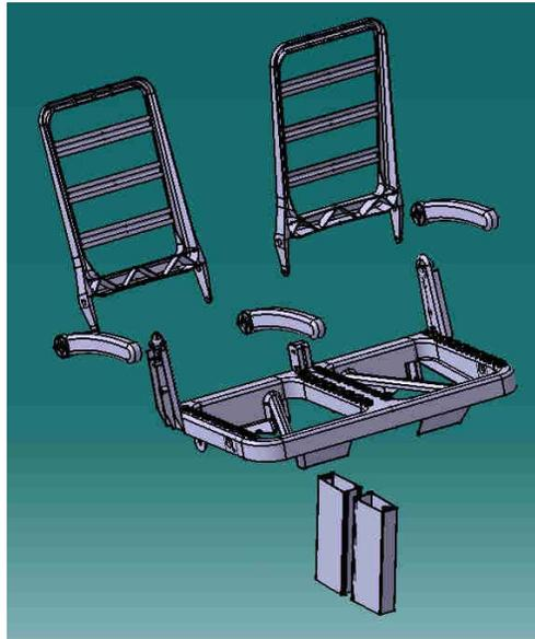
**Figure 21. Concept de siège passager monocoque utilisé par Multina et Meridian Technologies (2002)**
