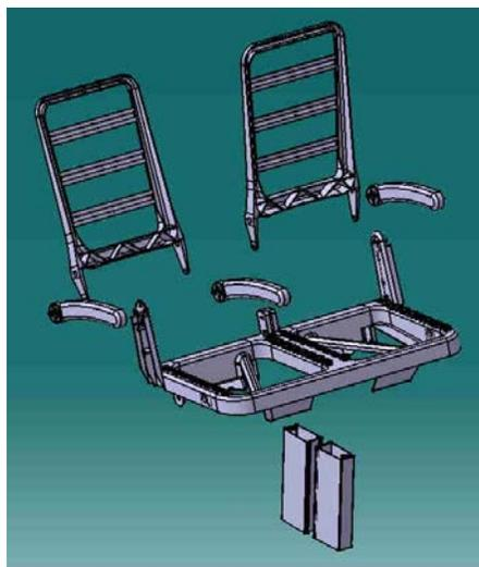
**Figure 1. Concept de siège passager monocoque utilisé par Multina et Meridian Technologies (2002)**
