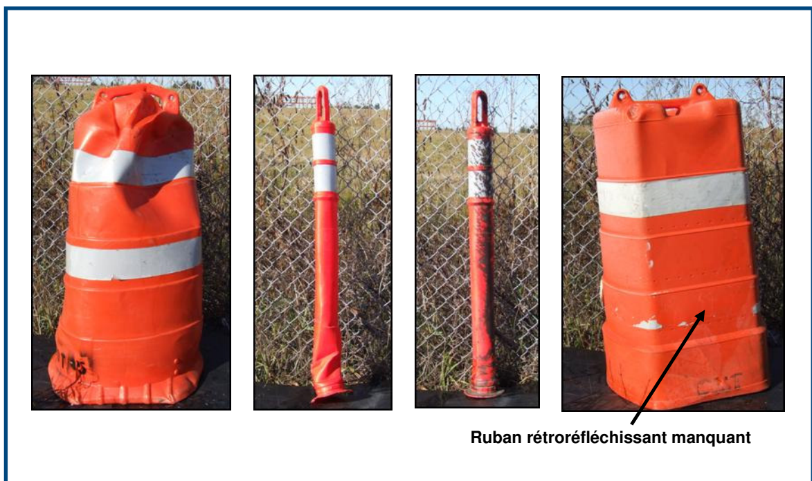
Figure 4-12: Exemples de barils et de balises tubulaires non acceptables
