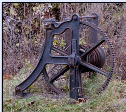
Figure 5 : Les trois premières images font parties d'un même plan signé par F. P. Rubidge et intitulé « Detailed Plan of the Machinery for Working the Lock Gates of the Beauharnois canal », 1843. Bibliothèque et Archives Canada. La quatrième image représente l'un des treuils, encore en place, actionnant l'une des portes d'une écluse. Bergeron Gagnon inc.
