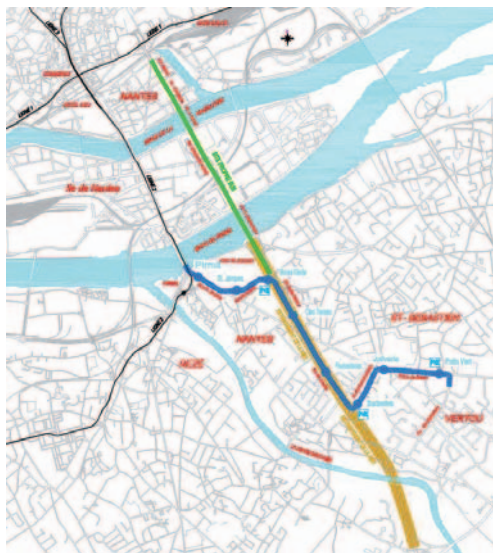
Entre Vertou et Nantes, le choix de BusWay® (bleu puis vert) plutôt que d'une nouvelle branche de tramway (bleu) initie un maillage du centre-ville tout en désengorgeant le tramway existant (gris) (source: Nantes Métropole)
