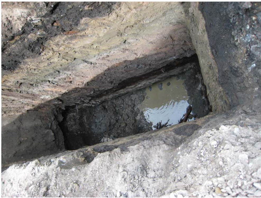
Photo n° 11. Tranchée TE-08-7 séquence stratigraphique complète, remblai, tourbe, fluvio glaciaire.
