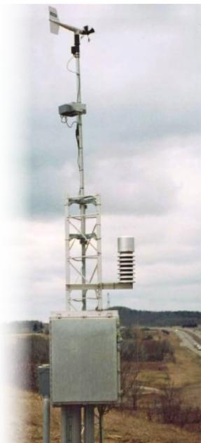
Les systèmes d'information météorologique routière (SIMR) fournissent des données détaillées sur les conditions météorologiques en bordure de route et sur la température de la chaussée. Ces données sont recueillies par des capteurs installés le long de la route et sur la chaussée. Un SIMR intégral comprend les relevés des données routières et des données météorologiques normalisées pour établir des prévisions météorologiques routières précises et pour
