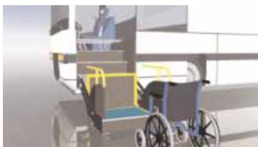
L'élévateur est rangé derrière la marche inférieure de l'entrée et s'étend pour présenter une plate-forme élévatrice avec des côtés, des mains courantes et une protection anti-basculement. Lorsque l'élévateur descend au sol pour l'embarquement, le plancher en haut des marches monte au niveau du plancher de la cabine.
