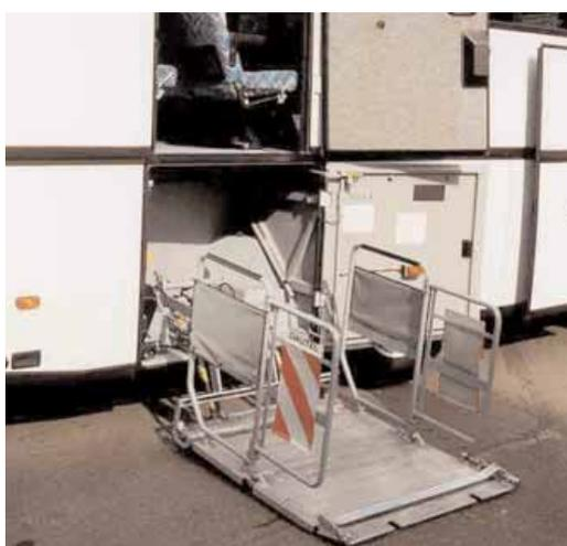
Cet élévateur est un modèle différent du précédent mais dispose d'un espace de rangement spécifique au-dessous de la porte d'accès des fauteuils roulants. La largeur de l'espace de rangement limite l'impact sur les compartiments bagages de chaque côté de l'élévateur.
