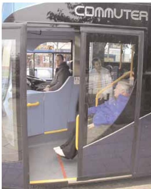
Ce véhicule allie les caractéristiques d'un plancher bas à l'avant du véhicule et d'un modèle à plancher élevé pour le reste. La zone avant à plancher bas permet un accès pour fauteuil roulant via une rampe et un espace fauteuil roulant.
