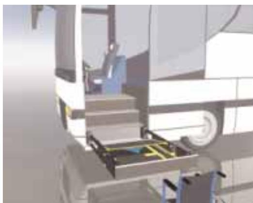
Un élévateur est nécessaire pour qu'un fauteuil roulant puisse accéder à la cabine d'un autocar type à plancher haut. Dans ce concept, l'élévateur est installé dans les marches de la porte d'entrée avant. Dans les gares routières et aux points d'arrêt, il est possible d'utiliser le même point d'accès pour les autres passagers ce qui peut constituer un avantage significatif lorsque l'accès sur le côté ou à l'arrière du véhicule est restreint ou impossible.
