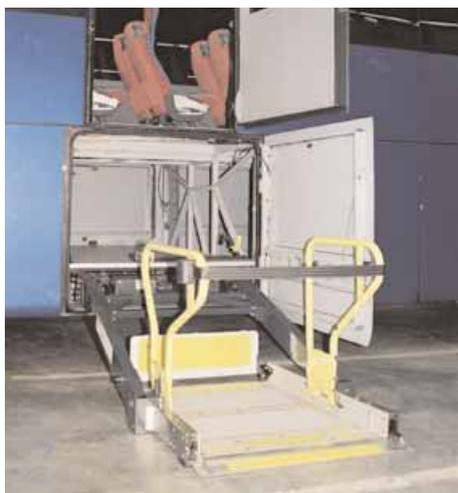
Dans le premier exemple, l'élévateur est rangé horizontalement dans la partie inférieure du compartiment bagages. Ce modèle, combiné à une très grande hauteur de plancher de cabine, autorise un espace bagages au-dessus du rangement de l'élévateur avec accès des deux côtés du véhicule.
