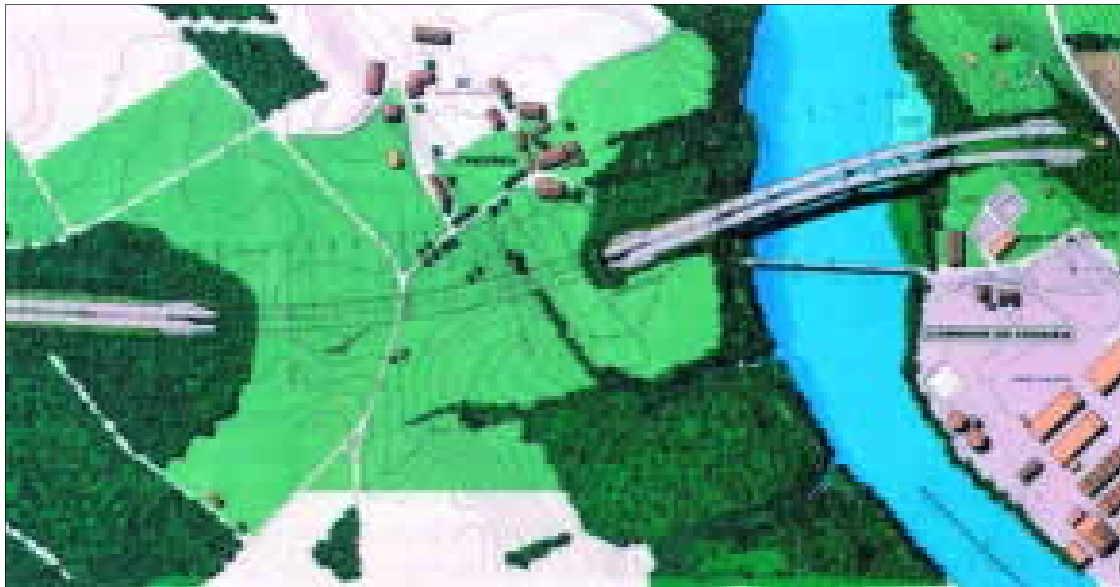
Dessin de l'étude d'intégration (1979) montrant la tranchée couverte protégeant le village de Chèvres.
