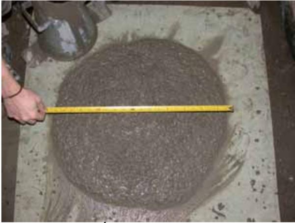
Figure 3 : Étalement du BRF (530mm)
