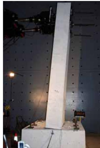
Figure 19 : Allure du pilier S2 à 370 mm de flèche
