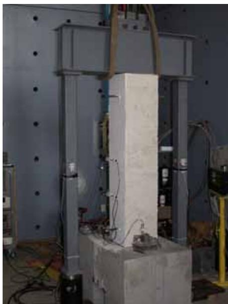
Figure 7 : Montage expérimental pour l'essai d'arrachement
