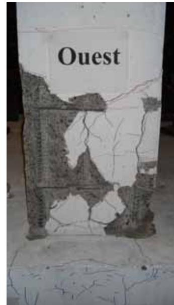
Figure 15 : État final du côté ouest de S1
