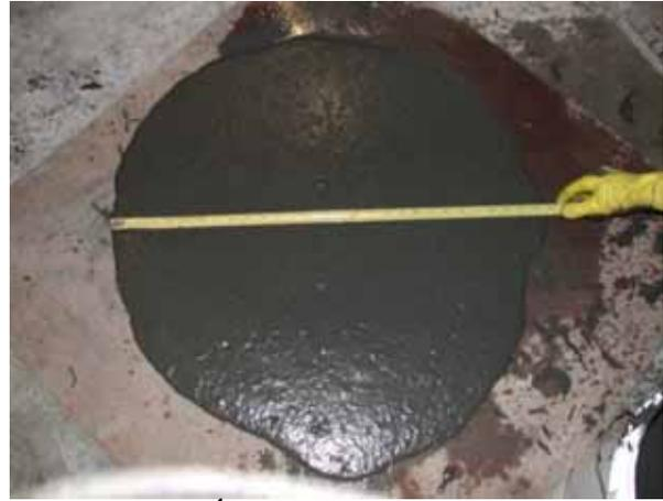
Figure 4 : Étalement du BFUP (710mm)
