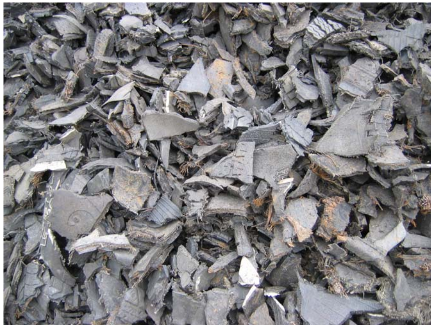
Photo 18 : Remblai de pneus déchiquetés
