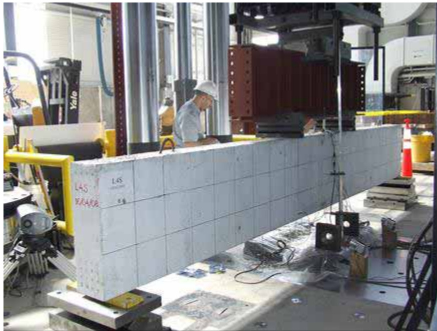
Figure 6 - Montage expérimental – Essai sur la poutre L4
