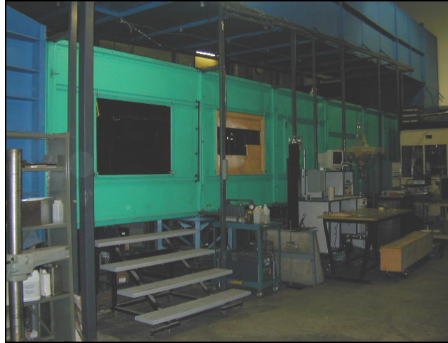
Figure 4 : Soufflerie de l'Université de Sherbrooke – vue de profil de la section d'essai
