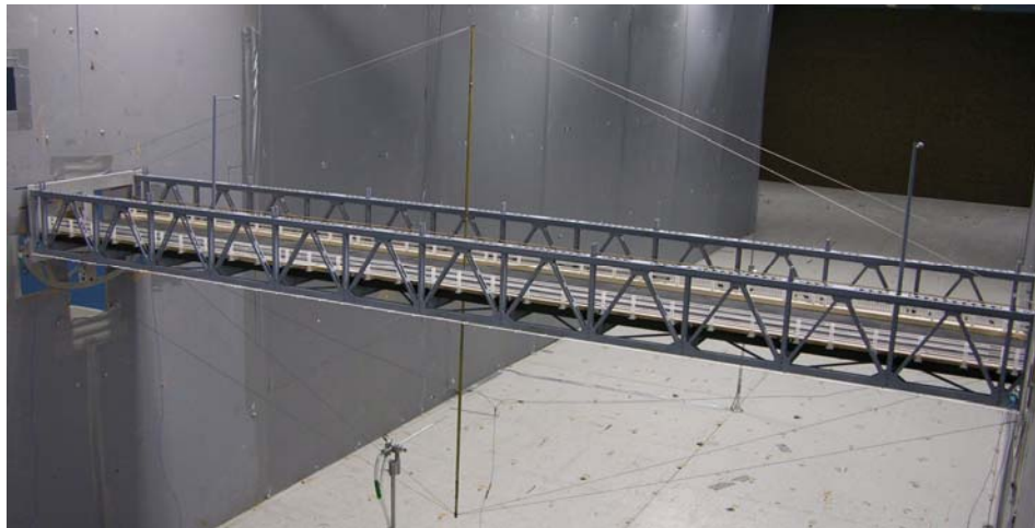
Figure 1 : Exemple d'une maquette de pont réduite réalisée dans le cadre du projet de L'île d'Orléans, Québec – 2 DDL, déplacements possibles en régime libre : vertical et en torsion
