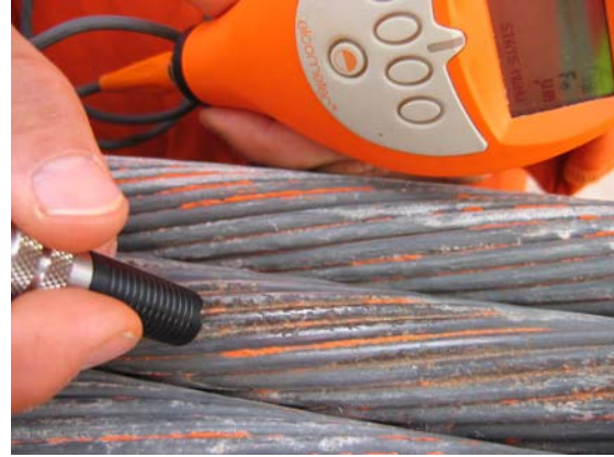
Figure 7 : Mesure de zinc par Elcometer
