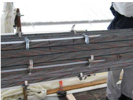
Figure 14 : Jauges SOFO, section de câble ouverte
