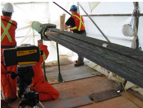
Figure 12 : Tests de vibromètre laser
