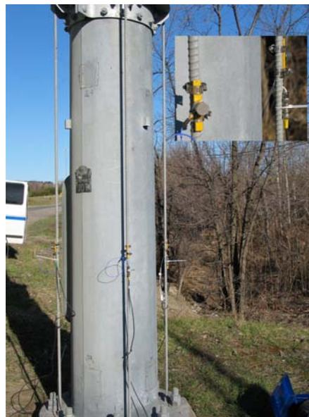
Figure 16 : Accéléromètre fixé sur une barre à haute résistance lors de la mesure de la tension dans celle-ci
