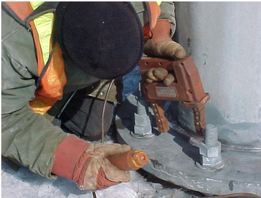
Figure 6 : Inspection par magnétoscopie de l'assemblage semelle – fût
